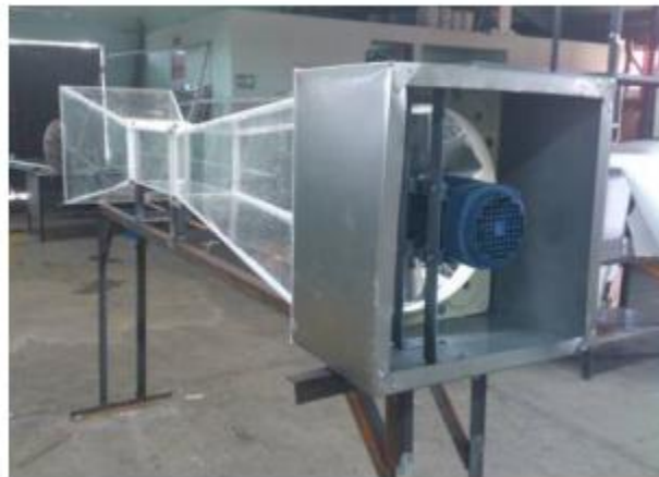
Figura 38. Túnel de viento hecho a partir de acrílico. Imagen. Fuente: Diseño y manufactura de túnel de viento subsónico de circuito abierto
