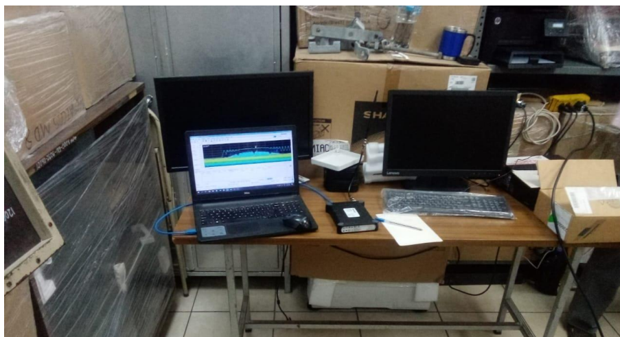
Figura 108. Equipo de prueba Analizador Tektronix RSA306B, antena 802.11n y PC con software para presentación de datos
