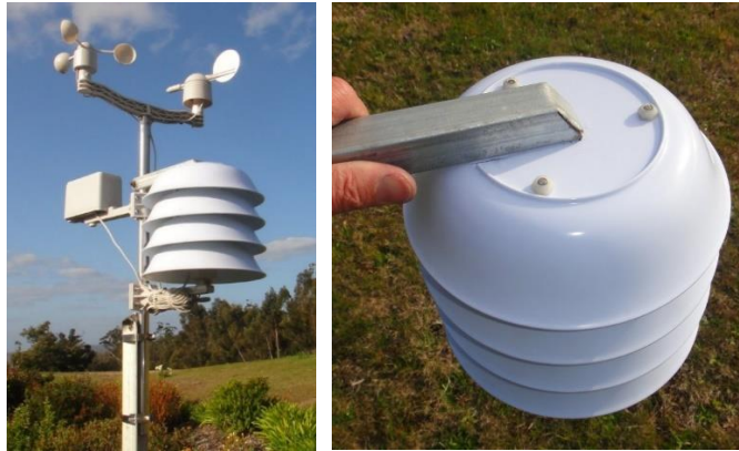
Figura 49. Abrigo térmico casera realizado a partir de vajilla de melamina. Fuente: https://aaybee.au/StevensonScreen.html
