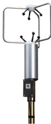
Figura 9. Anemómetro ultrasónico de tres dimensiones
