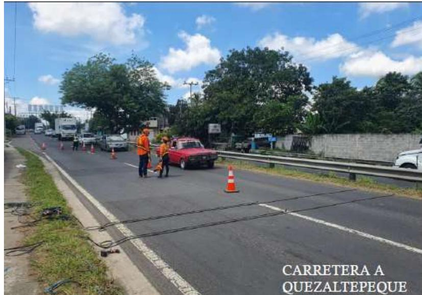
*Imagen 3. 3 Calibración del ROADPOD VT4, RN047W, tramo RN07W D - Dv Quezaltepeque - Dv San Juan Los Planes (LIB10N).*
