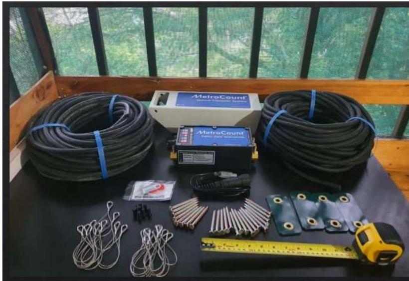
*Imagen 3. 6 Accesorios para la instalación del ROADPOD VT4
