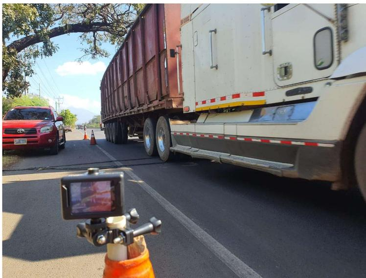
*Imagen 3. 5 Conteo vehicular utilizando una cámara de video.
