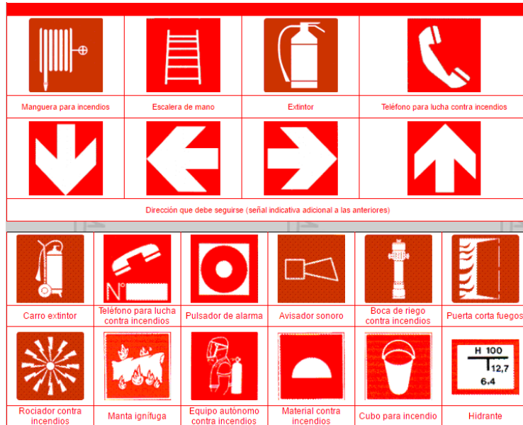
Ilustración 5: Señales de Protección Contra Incendios.
