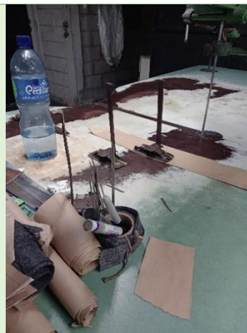
Ilustración 35 Riesgo de punzonamiento
