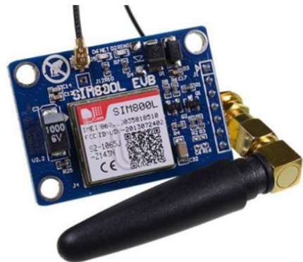
Imagen 4.5: GSM SIM800L EVB
