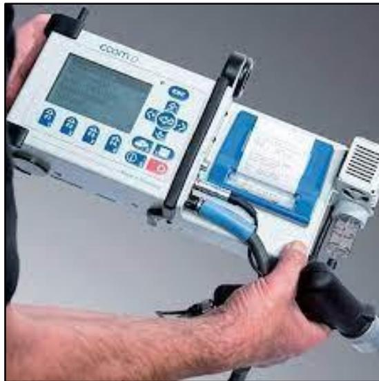
*Imagen 17: Analizador de gases de escape o Humos*
