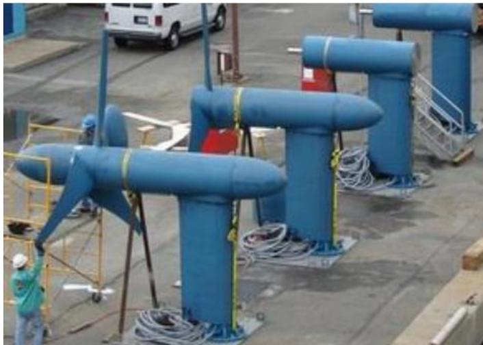
*Ilustración 18 Turbinas de marea (Verdant Power, 2016)*
