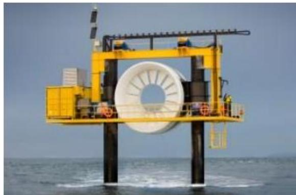
*Ilustración 21 Turbinas de marea (Open Hydro, 2014)*
