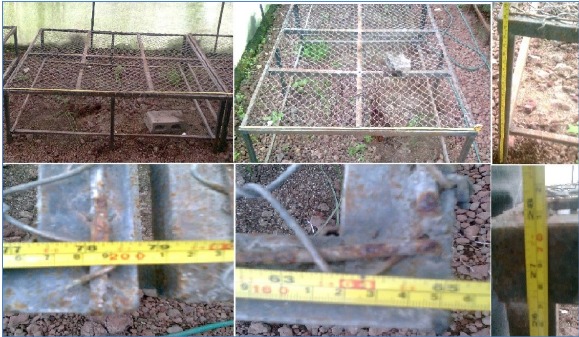
Figura 5. Dimensiones de las estructuras donde se colocaron las bandejas.
