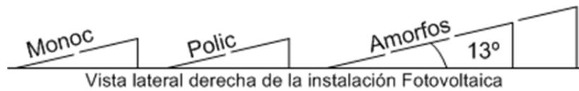
Figura 6.5.3. Vista lateral planta generadora fotovoltaica de CEL., las 3 tecnologías.
