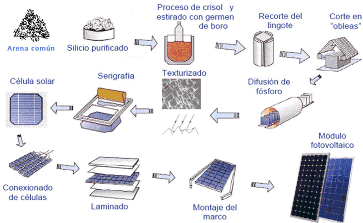
Figura 7.0. Etapas en el proceso de fabricación para una celda solar Monocristalina y Policristalina.
