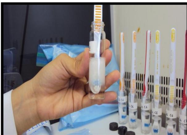
**INTRODUCCION DEL CEPILLO DENTAL AL TUBO DE ENSAYO CON PEROXIDO DE HIDROGENO AL 3%**
