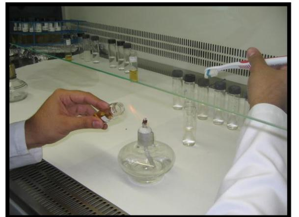
**FLAMEADO NUEVAMENTE DE LA BOQUILLA DEL TUBO DE ENSAYO**
