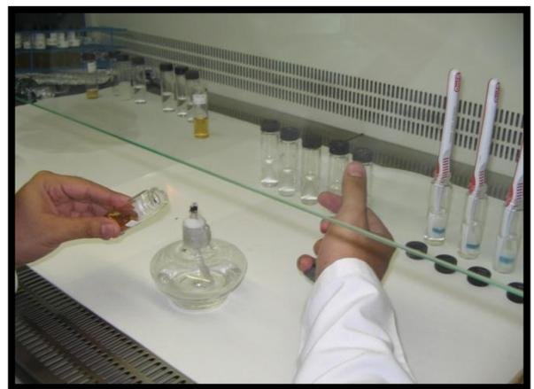
**FLAMEADO DE LA BOQUILLA DEL TUBO DE ENSAYO CON PEROXIDO DE HIDROGENO AL 3%**
