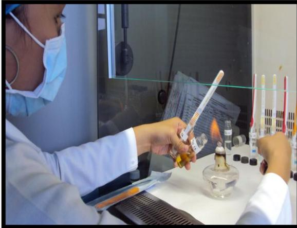
**FLAMEADO DE LA BOQUILLA DEL TUBO DE ENSAYO CON CALDO DE TRIPTICASA SOYA**
