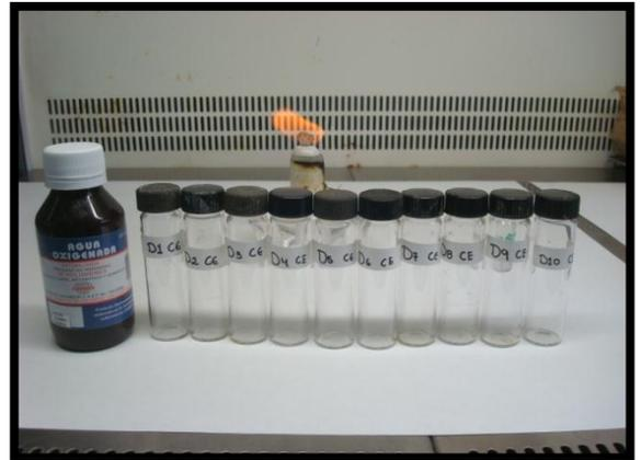
**TUBOS DE ENSAYO CON 10 ML. DE PEROXIDO DE HIDROGENO AL 3%**
