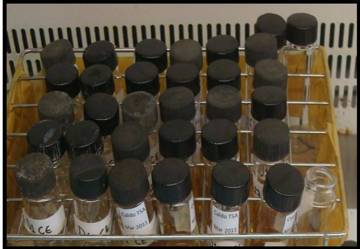
TUBO DE ENSAYO DE CONTROL AMBIENTE DESTAPADO DURANTE TODO EL PROCEDIMIENTO (1 POR INVESTIGADOR)
