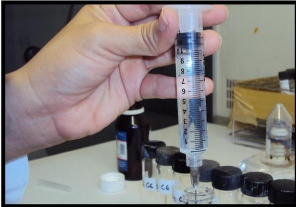
**INTRODUCCION DE 10 ML. DE PEROXIDO DE HIDROGENO AL 3% EN LOS TUBOS DE ENSAYO**
