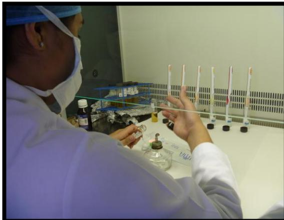
**FLAMEADO NUEVAMENTE DE LA BOQUILLA DEL TUBO DE ENSAYO**
