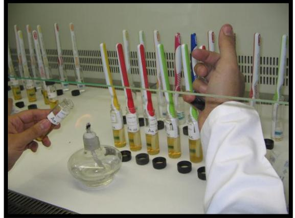
**FLAMEADO DE LA BOQUILLA DEL TUBO DE ENSAYO**
