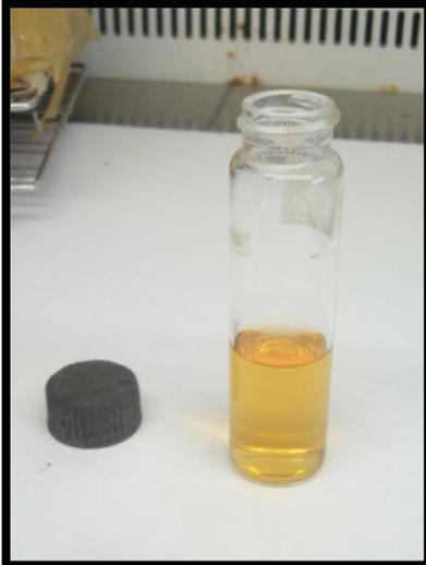
TUBO DE ENSAYO DE CONTROL AMBIENTE CON 10 ML DE CALDO DE TRIPTICASA SOYA.
