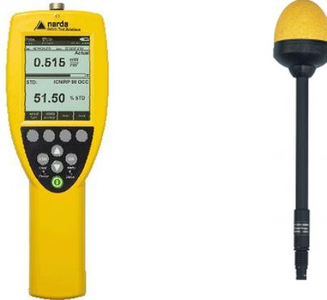
Modelo NBM-550 y sonda EF-0391 marca NARDA.
