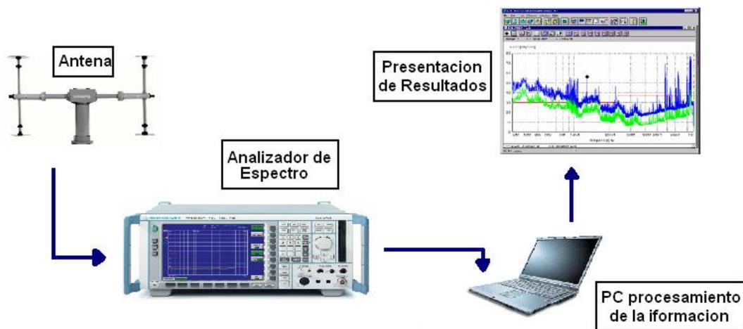
Figura 1.56: Esquema típico de un sistema de medición utilizando analizadores de espectro o receptores EMI.
