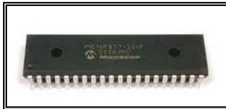
**Figura 2.7.a.** Microcontrolador PIC16F877.
