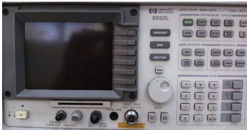
Figura 3 - 2. Analizador de espectro HP 8592L para primeras pruebas de caracterización del oscilador microonda.
