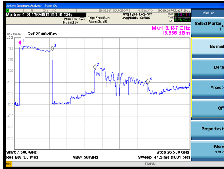
Figura 3 - 9. Espectro para una señal FM lineal de 6.8GHz a 12.4GHz y su segunda armónica. Salida de oscilador YIG.
