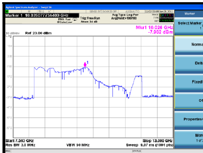
Figura 3 - 16. Señal registrada en el puerto LO, para señal inyectada en IF.
