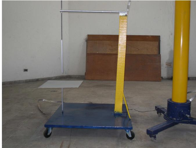
Figura H-11: Prototipo de espinterómetro punta-plano.
