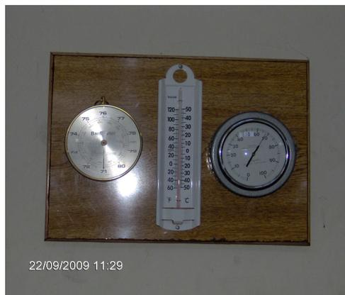
**Figura IV-1:** Barómetro, termómetro e higrómetro para la medición de presión, temperatura y humedad relativa en el laboratorio para ensayos de impulso tipo rayo con el generador de la EIE-UES.
