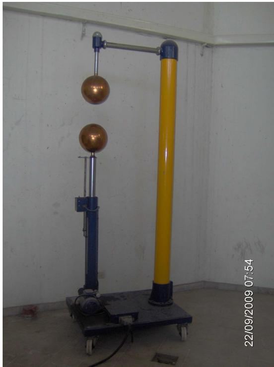
**Figura VII-2:** Espinterómetro o explosor de Esferas de la Escuela de Ingeniería Eléctrica de la Universidad de El Salvador.
