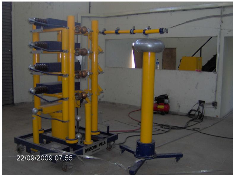
**Figura VI-1:** Generador de impulsos de la EIE-UES, donde se puede apreciar las 4 Etapas del generador y su par de esferas por etapa para el inicio de la descarga.
