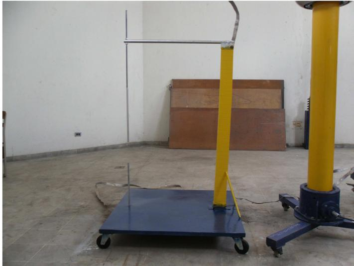
**Figura H-1:** Prototipo de espinterómetro punta-punta construido.
