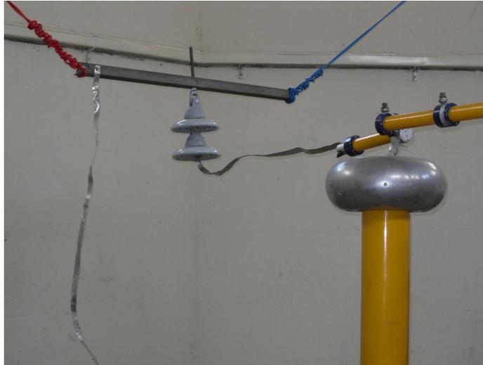
**Figura I-5:** Conexión de aislador de suspensión para pruebas de impulso tipo rayo en el generador de la EIE-UES.
