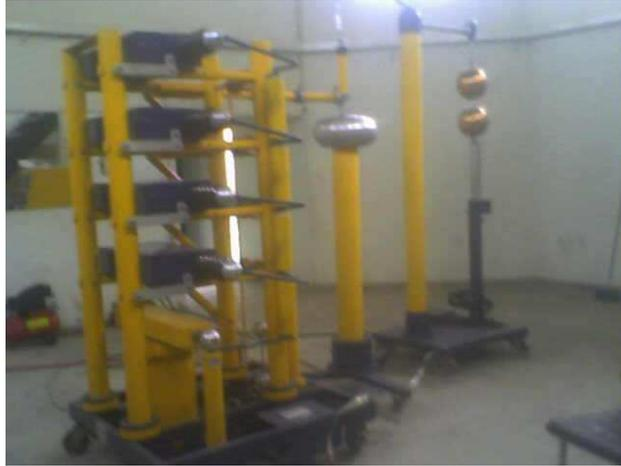
**Figura P-8:** Generador de impulsos tipo rayo de la EIE.
