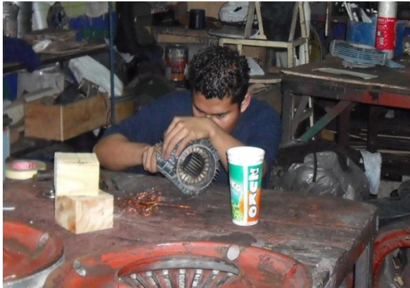
Extracción manual de bobinas
