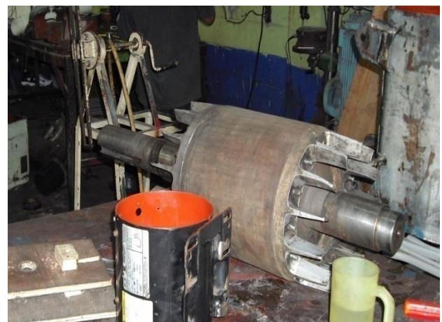
Verificación del estado de los anillos del rotor jaula de ardilla
