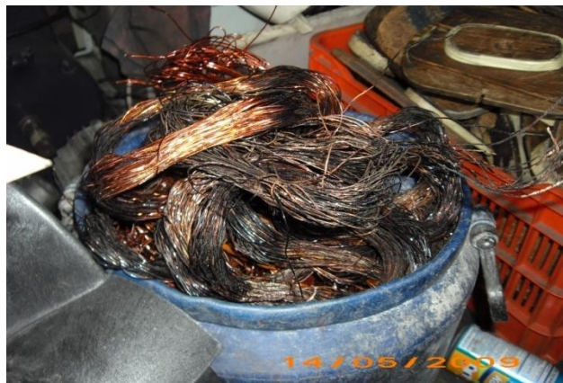
Bobinas retiradas del motor
