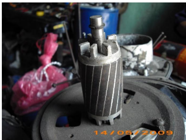
Verificación del estado de los anillos del rotor jaula de ardilla
