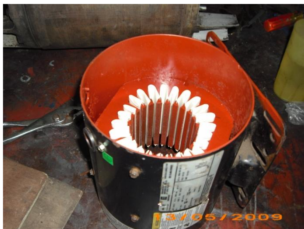
Estator con papel aislante en las ranuras
