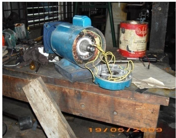
Motor con bobinas quemadas
