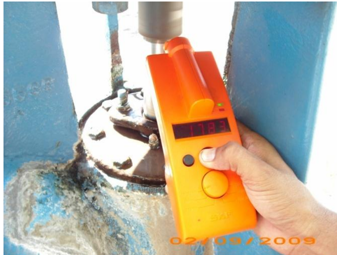
FOTOGRAFÍA QUE MUESTRA LA LECTURA DE RPM EN EL EJE DE UN MOTOR.
