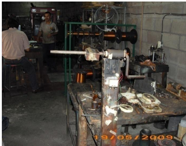
Bobinadora artesanal que tiene un dispositivo que cuenta las vueltas.
