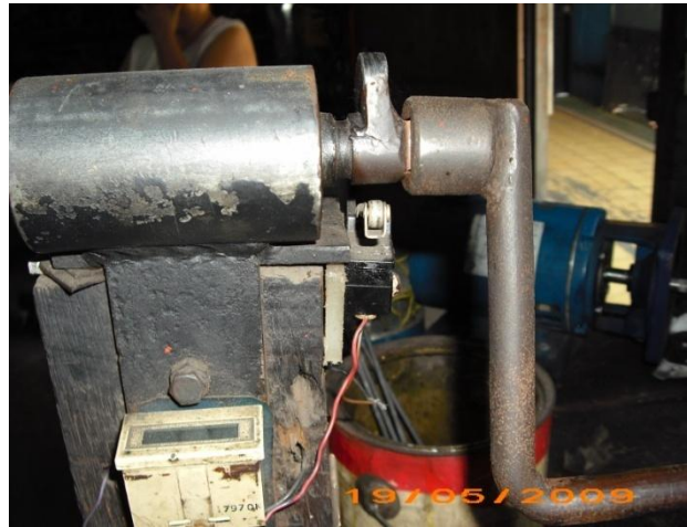
Bobinadora artesanal que tiene un dispositivo que cuenta las vueltas.
