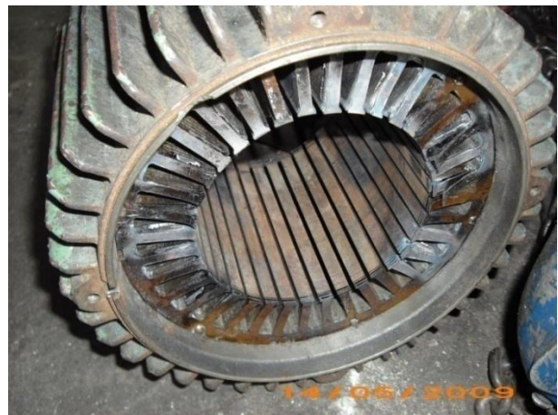
Daños muy graves en el estator
