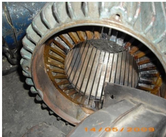
Resultado de la aplicación de una llama directa para extraer las bobinas
