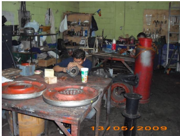
Extracción de las bobinas manualmente
