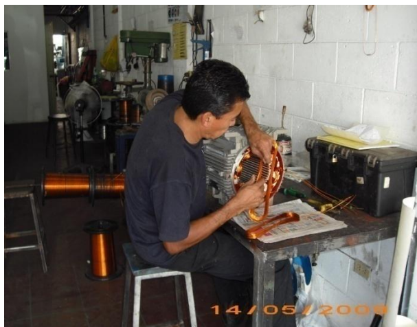
Montando las bobinas
