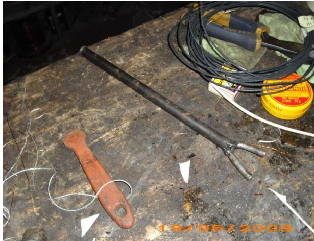
Instrumento artesanal para extraer las bobinas
