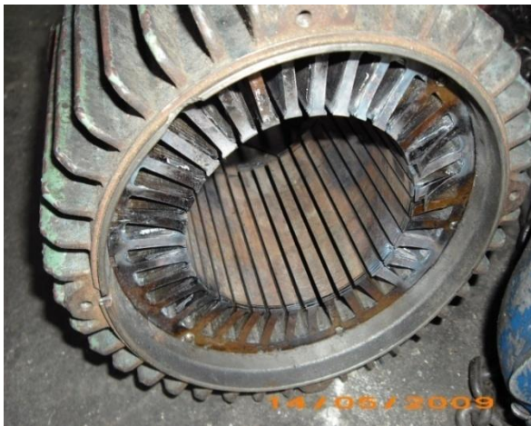
Resultado de la aplicación de una llama directa para extraer las bobinas
