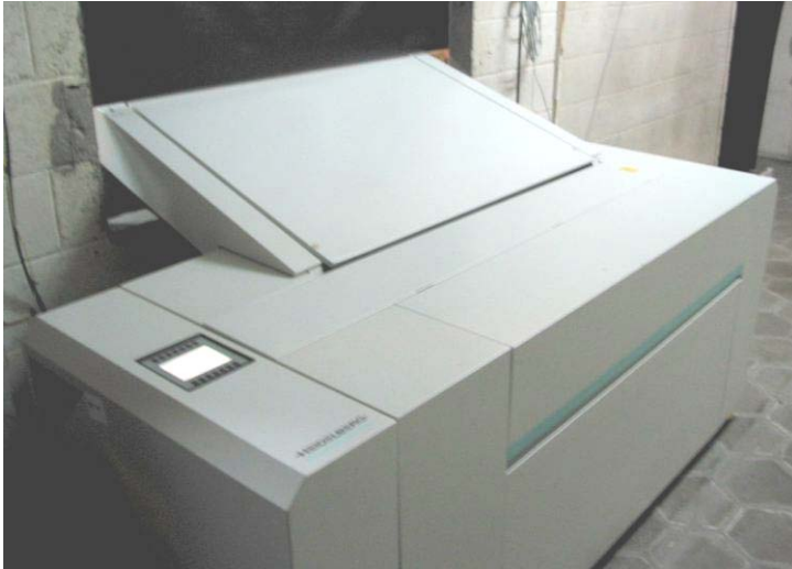
26 Maquina Heidelberg de sistema CTP
