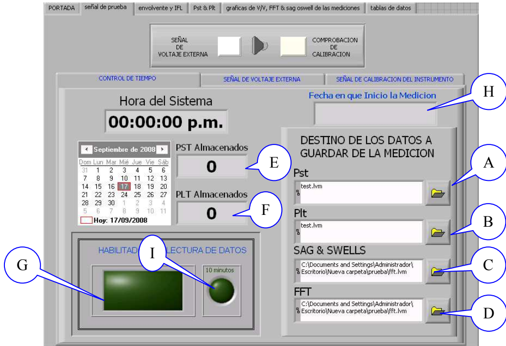
FIGURA 3.33 Panel de control de parámetros de tiempo y datos de recolección y almacenamiento.
