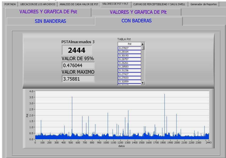
FIGURA A.4.e Panel que muestra los datos y gráfico de la medición de P_{st} con banderas.
