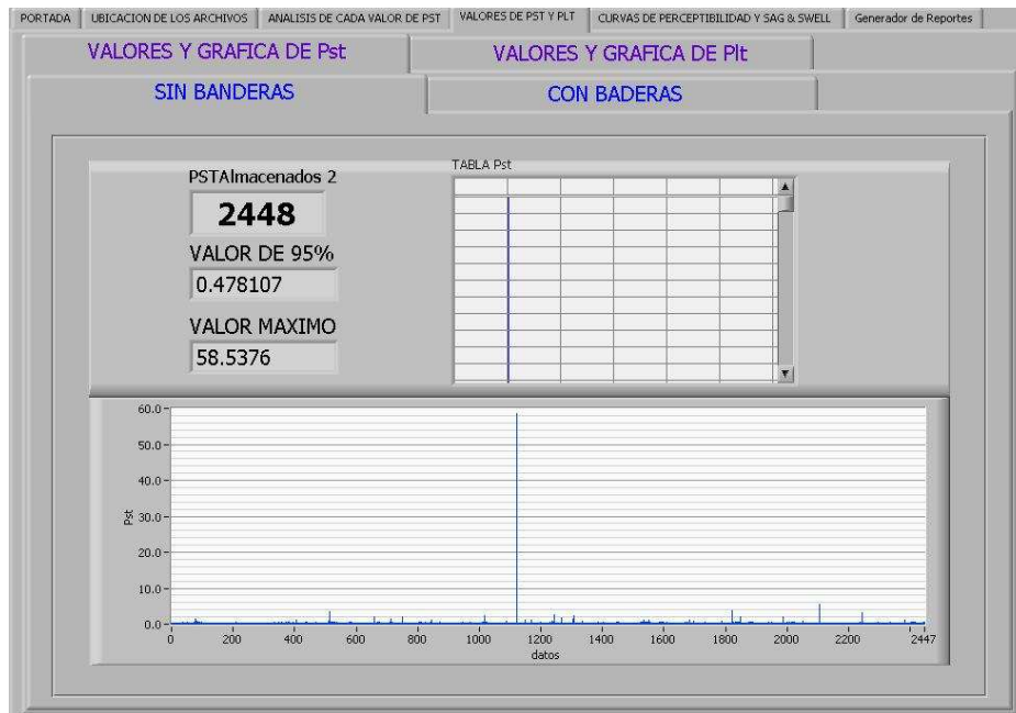
FIGURA A.4.d Panel que muestra los datos y gráfico de la medición de P_{st} sin banderas.
