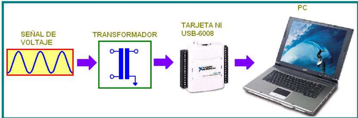
FIGURA 3.1 Diagrama de conexión para recolección de datos.
