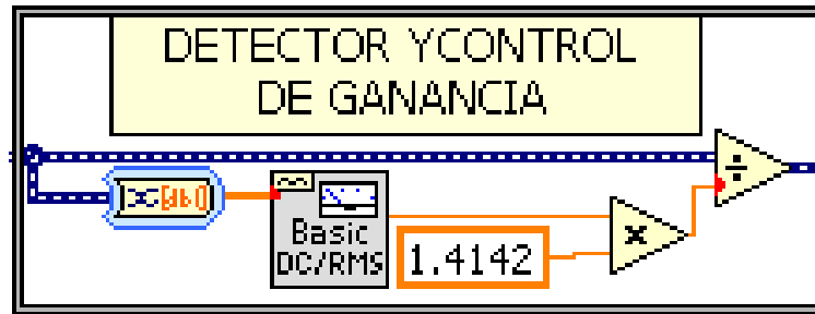
FIGURA 3.19 Código Labview para el detector y control de ganancia.
