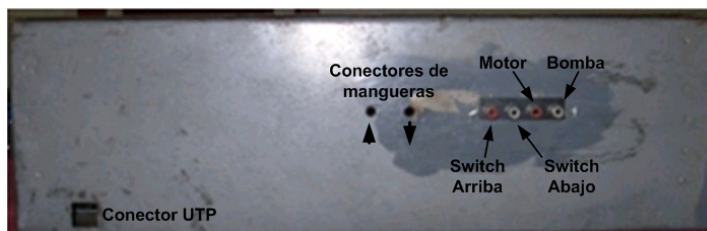
Figura 4.1 Esquema de conexión de mangueras, motor, bomba y switch
