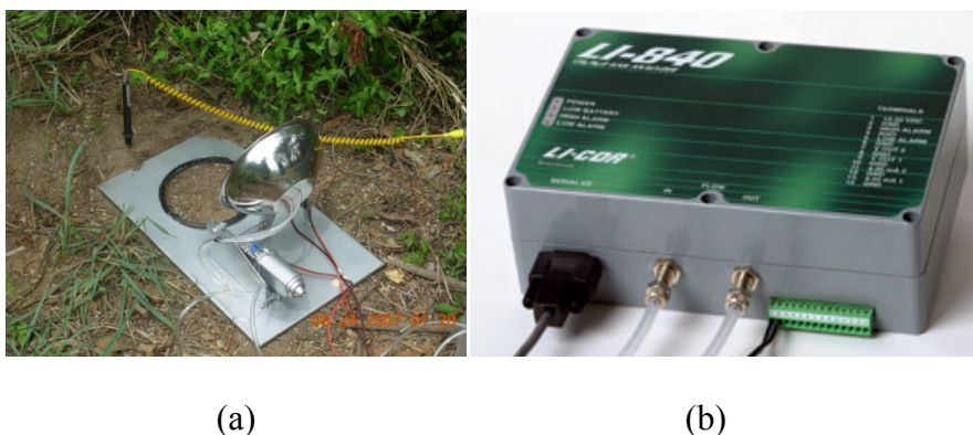
Figura 3.6. La figura (a) muestra la cámara de acumulación, mientras que la figura (b) muestra el analizador de \text{CO}_2 LI-840
