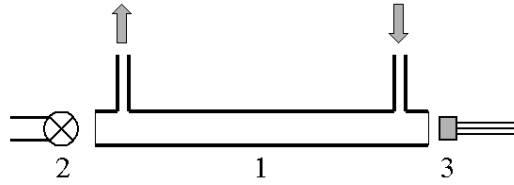
Figura 2.2 Fundamento de un sensor de CO 2 : 1. tubo de medida por el que se hace circular el gas, 2. lámpara emisora de infrarrojos, 3. sensor piroeléctrico.
