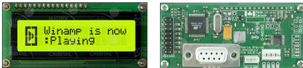
Figura 2. 8 Imágenes de la cara frontal y trasera del display LK162-12 de Matrix Orbital
