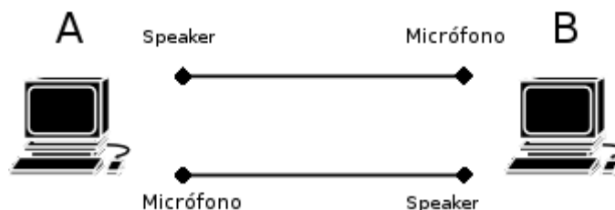
Figura 4.1. Conexión directa entre PCs (cruzado)
