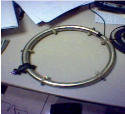
Figura 4.6 Antena usada para captación de rayos a través de campo magnético.
