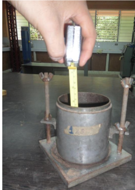
Figura 4. Medición de la altura del molde de compactación
