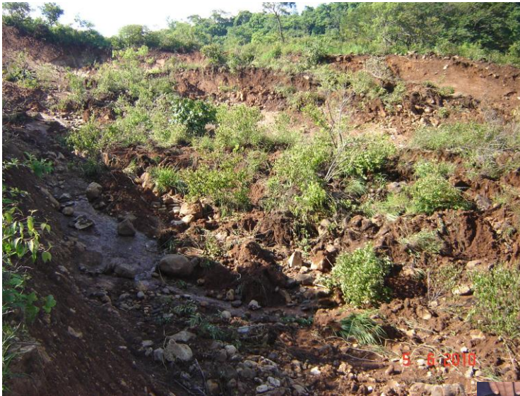
Fig. 4. Se puede observar el material que compone el deslizamiento, son arcillas plásticas (barro), y bloque de roca (piedras de diferente tamaño).
