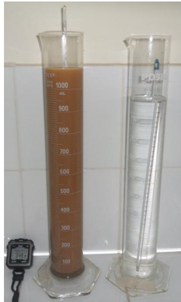
Figura 7 A la derecha se observa el termómetro inmerso en la probeta de control para leer la temperatura, en la probeta izquierda, lectura en la escala graduada del hidrómetro inmerso en la solución más suelo.
