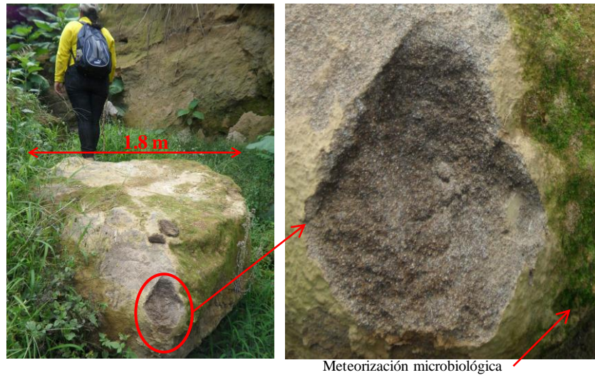
Figura 5 Arenisca que forma roca saprolítica, con presencia de bacterias que producen meteorización microbiológica, color verdusco. Ubicación al interior de la cárcava, a unos 160m desde la corona.
