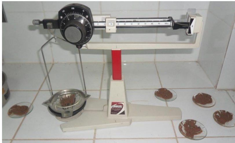
Figura 6 Determinación de la masa del vidrio reloj más los hilos de arcilla húmeda o con las muestras para determinar el límite líquido.
