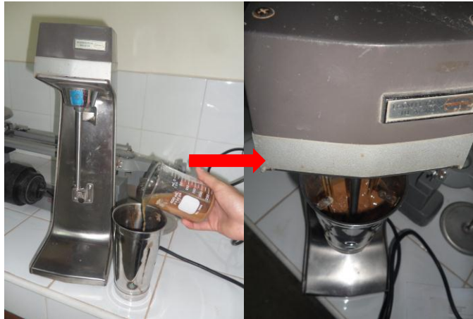
Figura 6 Transferencia de la lechada al vaso de la batidora para iniciar el mezclado mecánico por un minuto.
