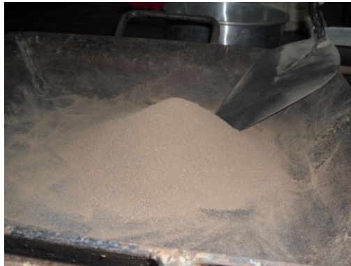
Figura 2 Reducción de muestra, representativa de campo, a tamaño de prueba por apilado en miniatura.
