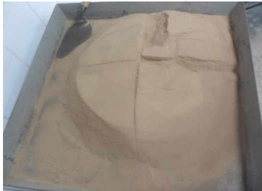
Figura 2 Reducción por cuarteo manual, de la muestra representativa de campo, a tamaño de prueba.
