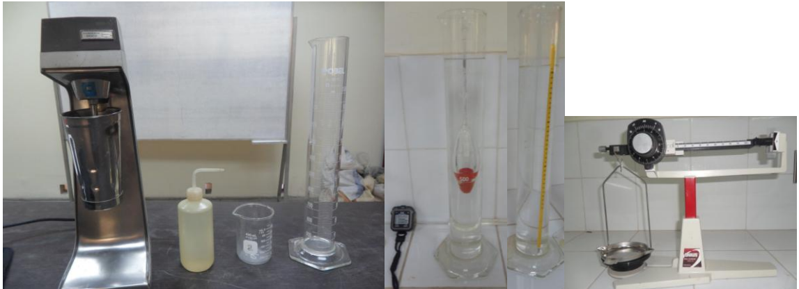
Figura 1 Equipo utilizado para realizar el ensayo hidrométrico.
