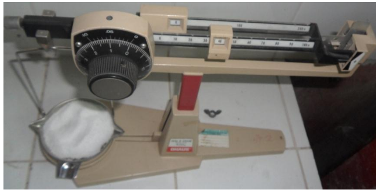
Figura 3 Determinación de la masa de Hexametáfosfato de Sodio.
