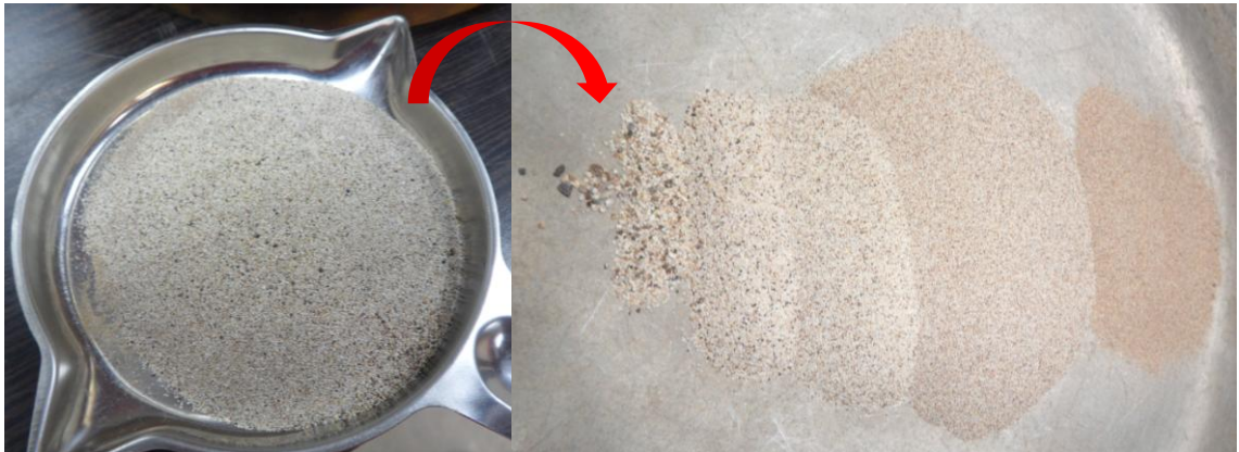
Figura 9 A la izquierda, muestra de suelo seco sin tamizar, al lado derecho, se presentan las fracciones de granos retenidos en las mallas No. 20, 40, 60, 100, 200 y lo que pasa la No. 200, de izquierda a derecha.
