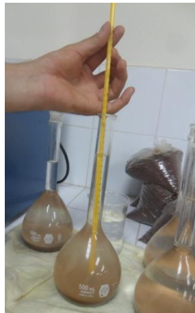
Figura 5 Verificación de temperatura de ensayo 38 .
