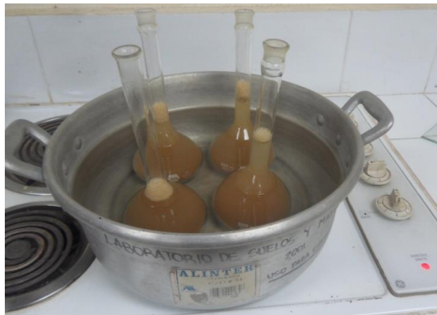
Figura 3 Aplicación de calor para extraer el aire del suelo. La fotografía no representa las muestras verdaderas.
