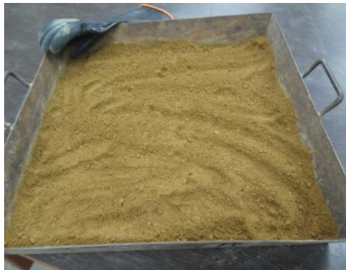
Figura 2 Reducción por cuarteo manual, de la muestra representativa de campo, a tamaño de prueba.
