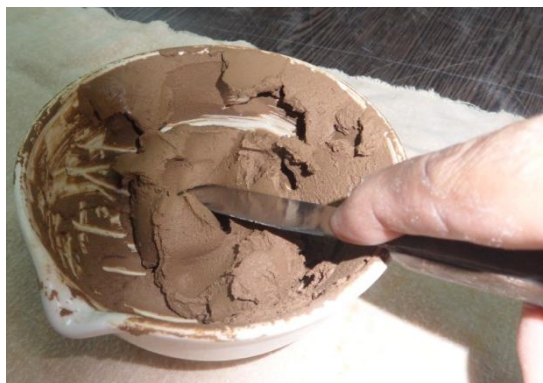
Figura 2 Remezclado del suelo arcilloso previo a realizar ensayo de límite líquido.
