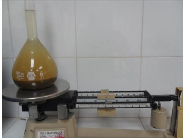
Figura 5 Determinación del peso de matraz, suelo y agua a temperatura de ensayo.
