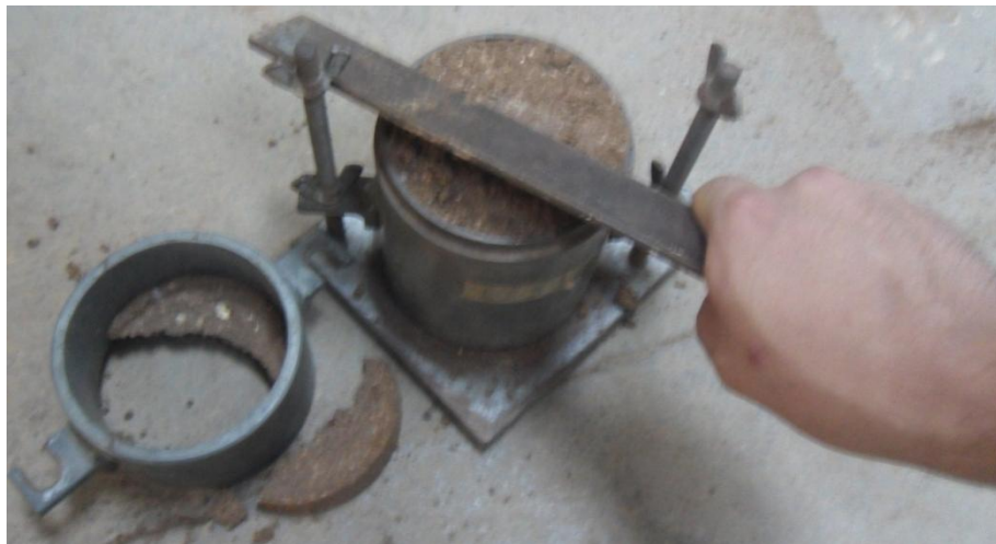
Figura 8. Corte y nivelación del suelo compactado en la parte superior del molde.
