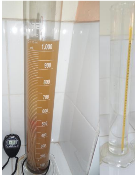
Figura 7 A la derecha se observa el termómetro inmerso en la probeta de control para leer la temperatura, en la probeta izquierda, lectura en la escala graduada del hidrómetro inmerso en la solución más suelo.
