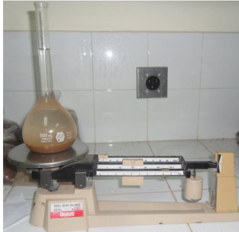
Figura 5 Determinación del peso de matraz, suelo y agua a temperatura de ensayo.
