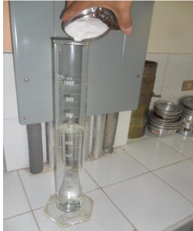
Figura 4 Mezcla del agua con el defloculante blanco para formar la solución dispersante.
