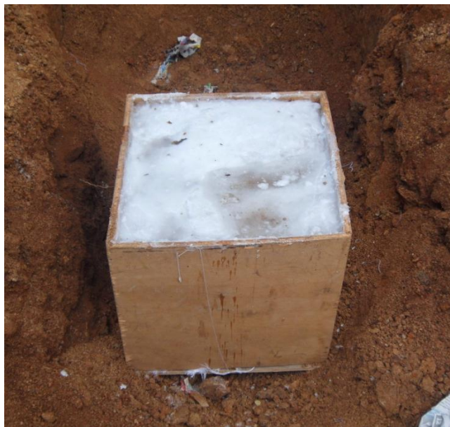
Figura 3.16. Protección in situ de la muestra inalterada de suelo.
