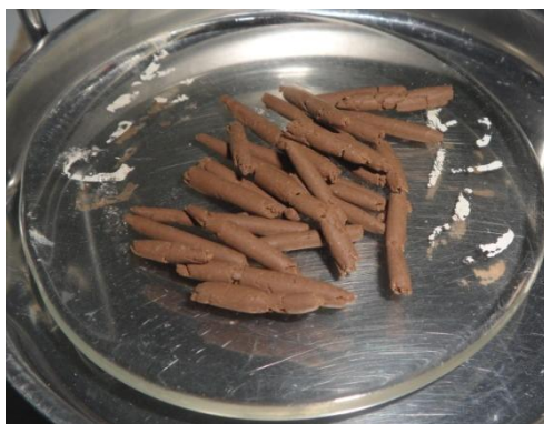
Figura 5 Hilos de suelo resquebrajado para determinar el valor del límite plástico de las arcillas.
