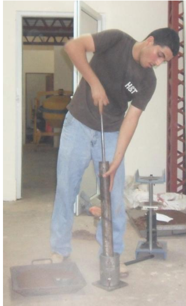
Figura 7. Compactación de cada capa de suelo agregada.
