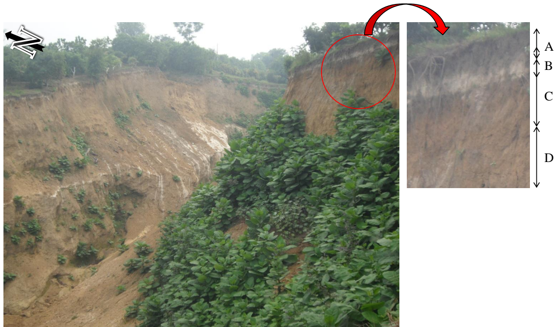
Figura 8 Estratos en ladera sur de la cárcava, siendo “A”, humus de 1.5m de espesor, “B” representa cenizas volcánicas blanquesinas de 1.0m de espesor, “C” y “D” representan tobas litificadas de unos 24.5m de espesor.
