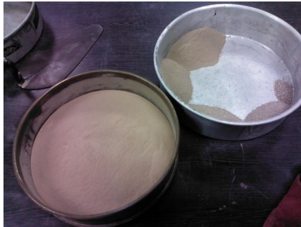
Figura 9 A la izquierda, se observa la fracción que pasó la malla No. 200; a la derecha y en la charola gris, se visualizan las fracciones de granos retenidos en las mallas No. 20, 40, 60, 100 y 200, en sentido horario desde la derecha.
