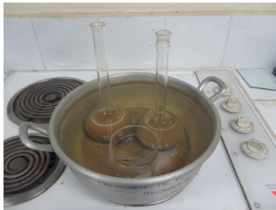
Figura 3 Aplicación de calor para extraer el aire del suelo.
