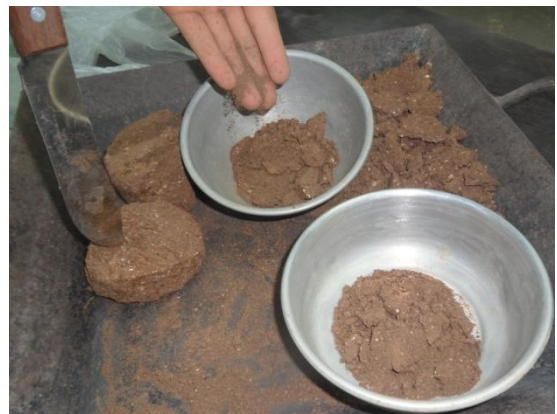
Figura 11b. Toma de muestra para determinar la humedad secada al horno.
