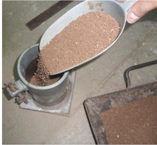
Figura 6. Llenado del molde con capas de suelo
