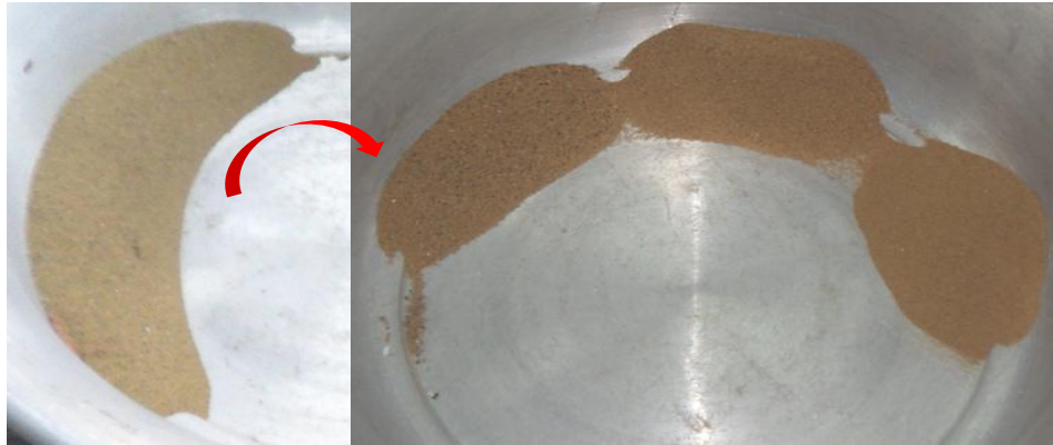
Figura 9 A la izquierda, muestra de suelo seco sin tamizar, al lado derecho, se presentan las fracciones de granos retenidos en las mallas No. 40, 60, 100, 200 y lo que pasa la No. 200, de izquierda a derecha.
