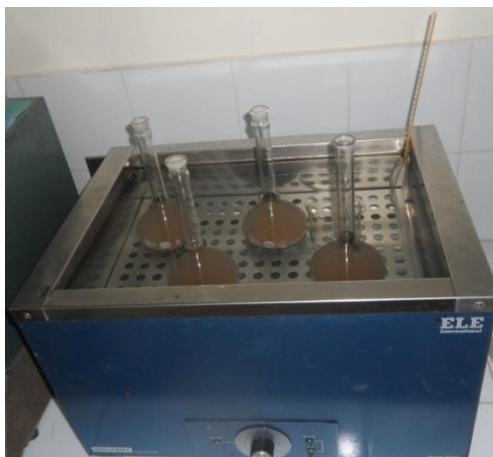
Figura 4 Baño María durante 24 horas para lograr equilibrio térmico, posterior a desairado.
