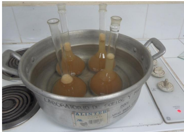
Figura 3. Aplicación de calor para extraer el aire del suelo.
