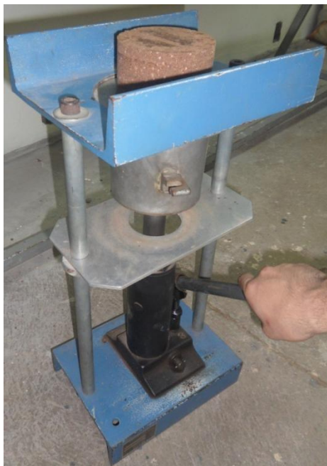
Figura 10. Extracción del espécimen compactado con ayuda del gato hidráulico
