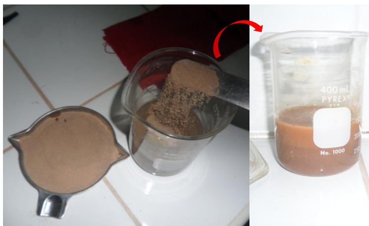
Figura 5 Mezcla de la muestra de suelo con 125 ml de solución dispersante y reposo durante 16 horas.
