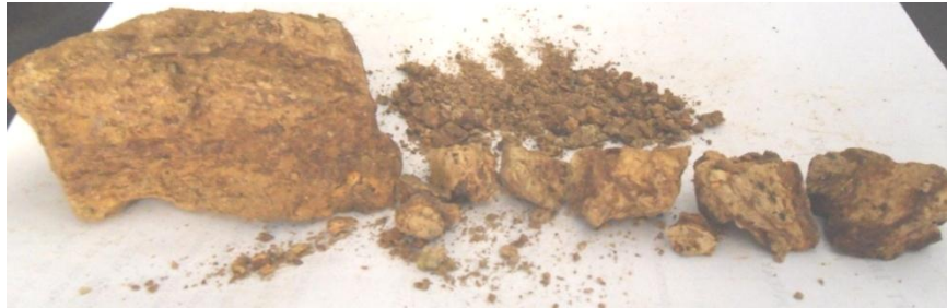
Figura 7 Tobas rojizas, fácilmente disgregables, con meteorización biológica rápida y oxidación.
