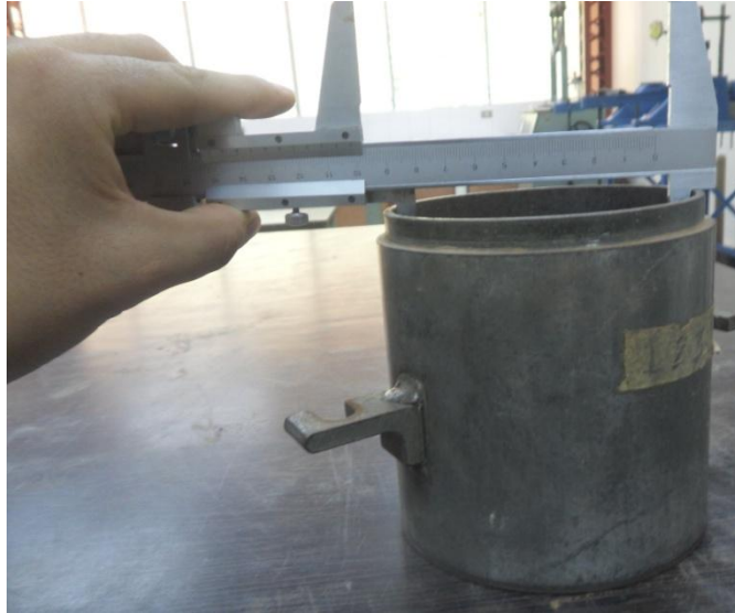
Figura 2. Medición del diámetro interno del molde.
