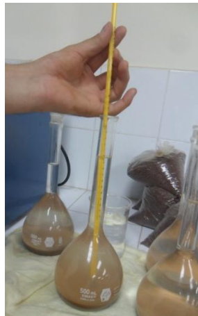
Figura 5 Verificación de temperatura de ensayo 19 .
