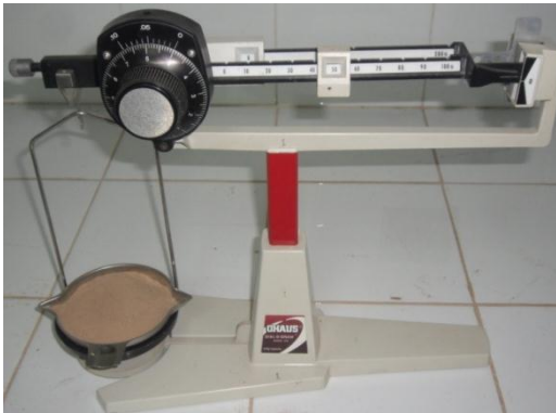
Figura 1 Pesado y registro de las masas de arcilla, secadas al horno, previo a introducir a los matraces
