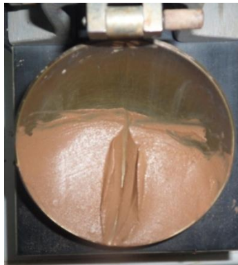
Figura 4 Unión de unos 13mm en el corte, después de proporcionar los golpes.
