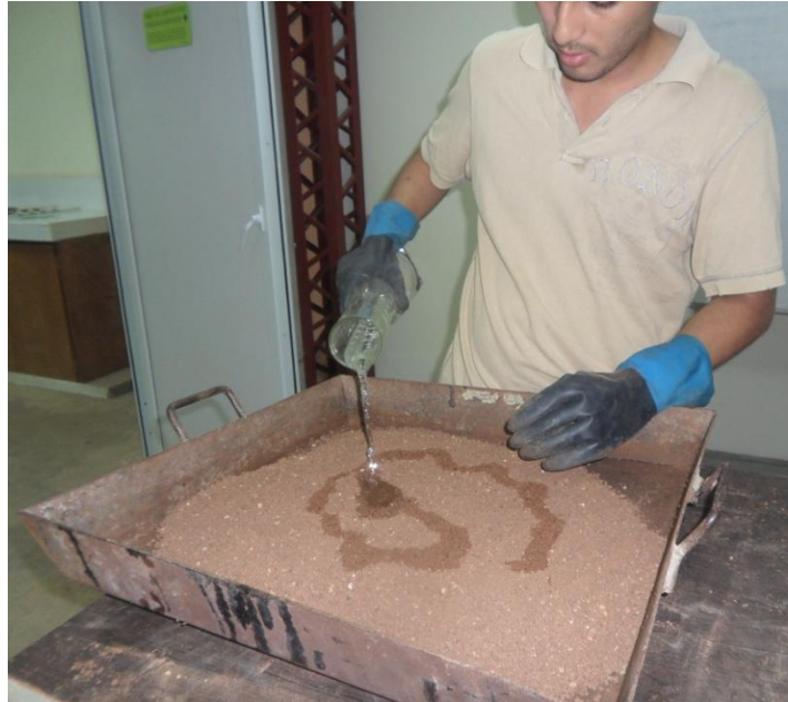
Figura 5. Agua agregada a cada muestra a compactar.
