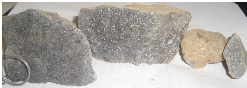
Figura 6 Rocas efusivas básicas-intermedias con incrustaciones de cristales de Sílice y Plagioclasas, pórfidos andesíticos en los alrededores de la cárcava, diámetros de 5 a 15 cm.
