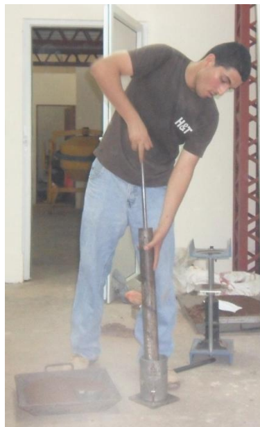
Figura 7. Compactación de cada capa de suelo agregada.
