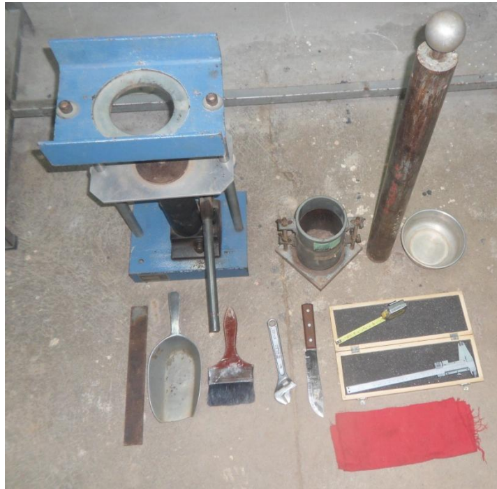
Figura 1. Equipo necesario para realizar el ensayo Proctor T-180
