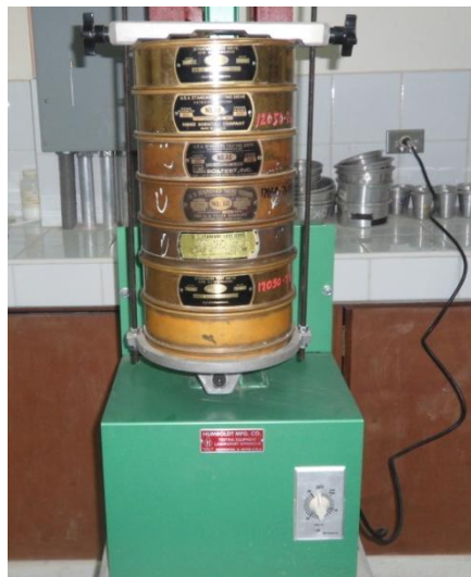
Figura 8 Colocación de la muestra de suelo seco en la malla No. 10, antes de ser tamizado en el Rop-Tap.
