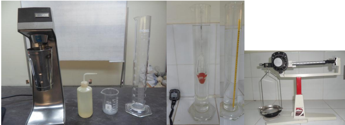
Figura 1 Equipo utilizado para realizar el ensayo hidrométrico.
