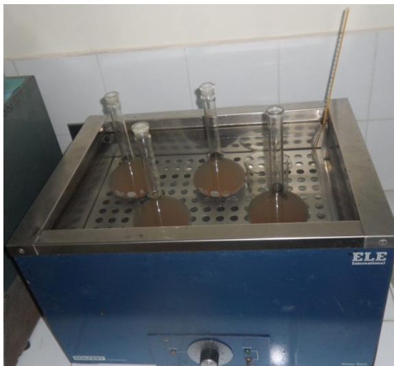
Figura 4 Baño María durante 24 horas para lograr equilibrio térmico, posterior a desairado.
