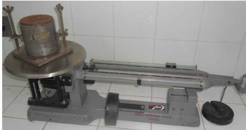
Figura 9. Medición de la masa del molde, collarín y suelo compactado.
