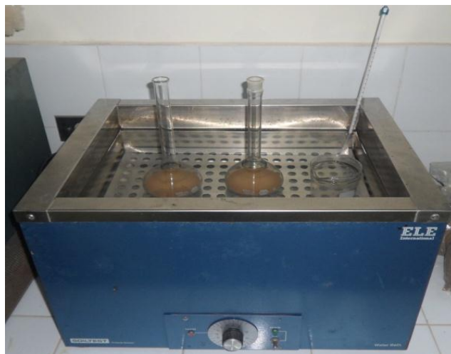
Figura 4 Baño María durante 24 horas para lograr equilibrio térmico, posterior a desairado.
