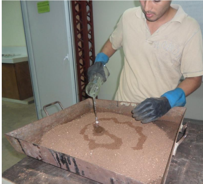
Figura 5. Agua agregada a cada muestra a compactar. Esta muestra no es el verdadero suelo.
