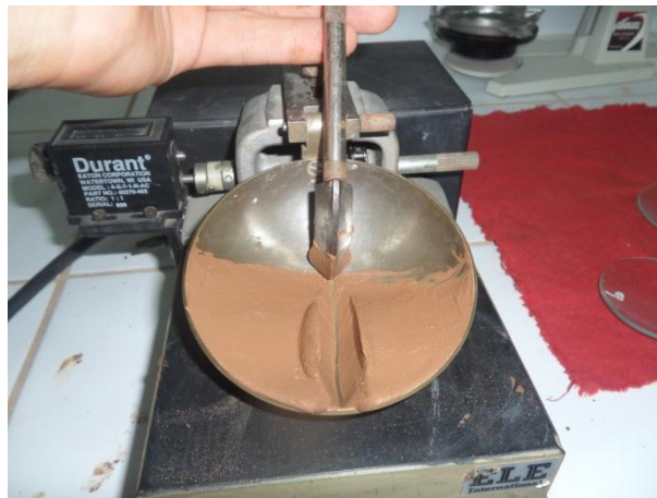
Figura 3 División en dos partes de la muestra de suelo para realizar límite líquido con diferente humedad para cada punto.
