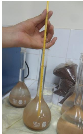
Figura 5 Verificación de temperatura de ensayo 29 .
