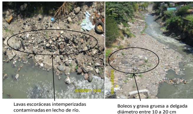
Figura 2.8 Estructura Geológica en cauce de la Quebrada El Arenal, en las cercanías del Barrio Candelaria, San Salvador.
