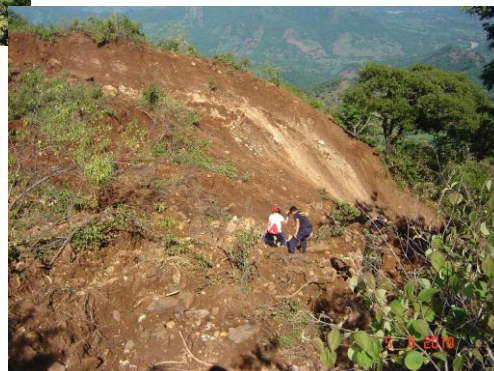
Fig. 2. Talud expuesto en la ladera izquierda aguas abajo y depósito de materiales derrumbados en el fondo de la quebrada.
