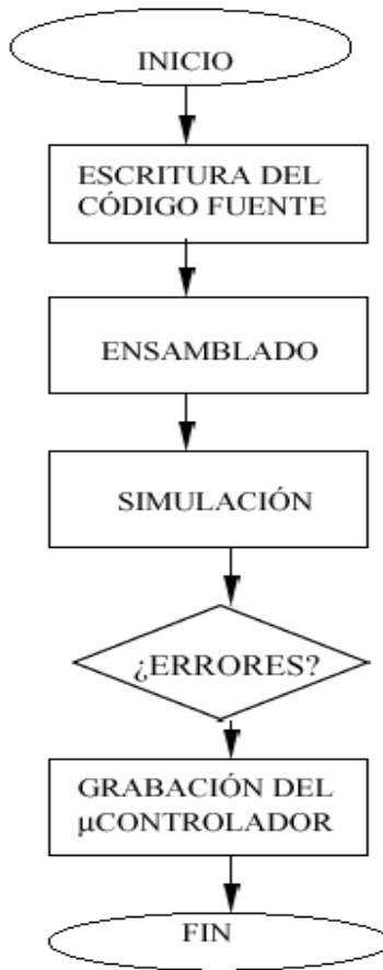
Figura 2.20 secuencia de programación del microcontrolador 16F874A.
