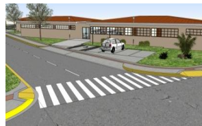
Banda de separación entre la zona peatonal y de tráfico.
