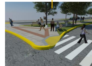
Construcción de rampas para sillas de ruedas
