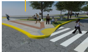
Banda de separación entre la zona peatonal y de tráfico
