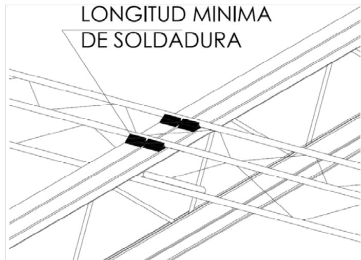
**Fig. 4.100. Longitud mínima del filete de soldadura.**
