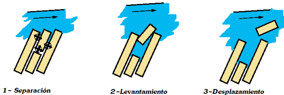
FIGURA N°2.16: Representación Esquemática del Proceso de Erosión en Roca (Yang 1973) 1) Separación, 2) Levantamiento y 3) Desplazamiento.
