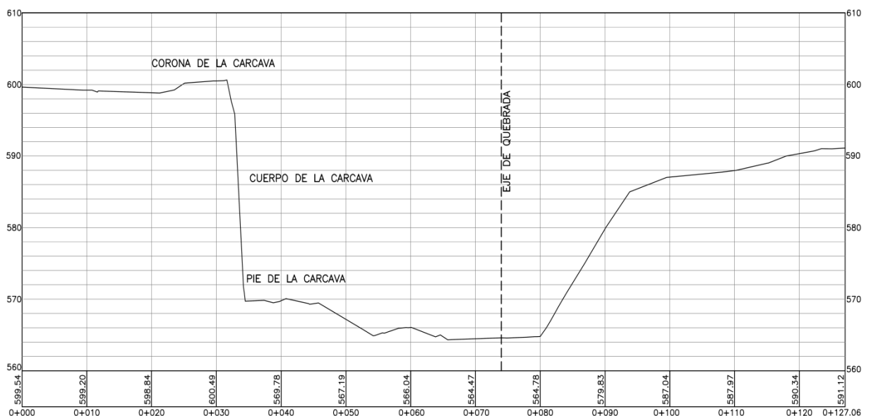
FIGURA N°5.2: Perfil longitudinal de la Cárcava, corresponde al perfil 1 de la planta topográfica (Figura N°5.1), sin escala.
