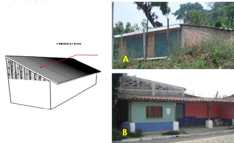
Imagen 99. Cubierta a una agua. (A) y (B).
