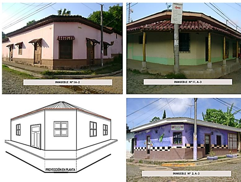
Imagen 93. Dibujo Tipológico 5. Esquina Ochave con hueco de ventana.
