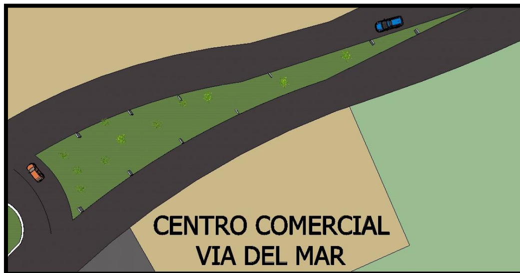
Figura 5.17 Incorrecta colocación de MUPI en retorno (VISTA EN PLANTA)
