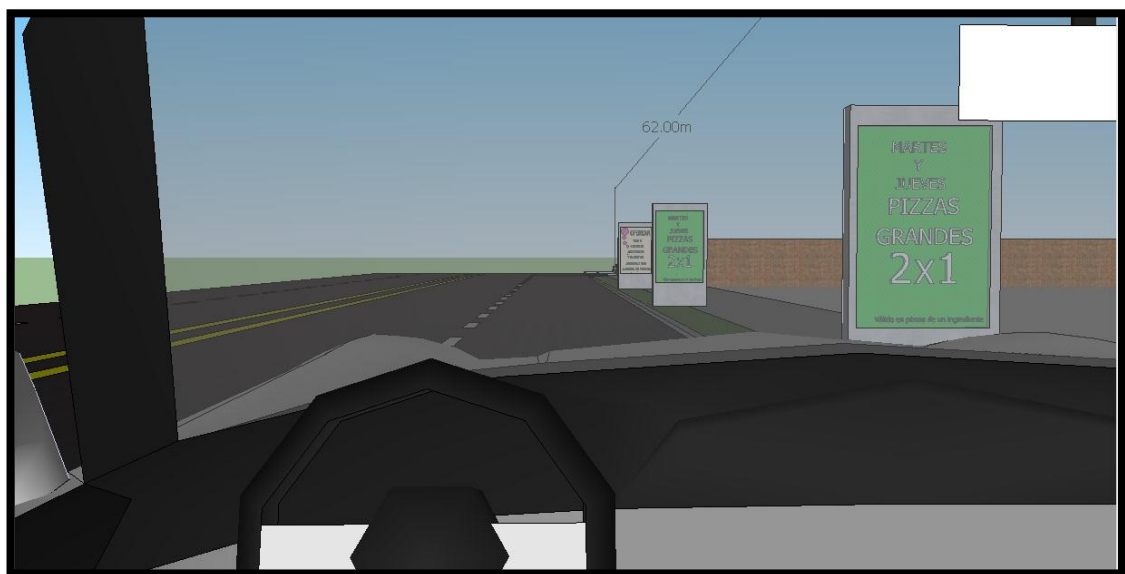
Figura 5.5 Colocación incorrecta de MUPI en vía urbana con velocidad de 50 Km/h (VISTA CONDUCTOR QUE SE CONDUCE EN VIA PRINCIPAL)
