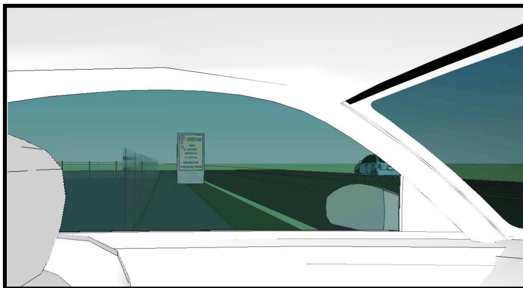
Figura 5.11 Colocación incorrecta de MUPI obstaculizando la salida de un establecimiento comercial (VISTA CONDUCTOR SALIENDO DE ESTABLECIMIENTO)
