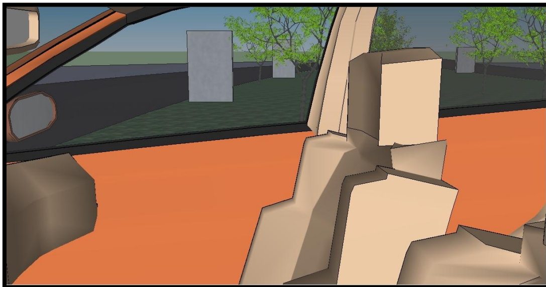
Figura 5.21 Incorrecta colocación de MUPI en retorno obstaculizando la visual de los conductores que utilizan el retorno (VISTA DEL USUARIO DEL RETORNO)
