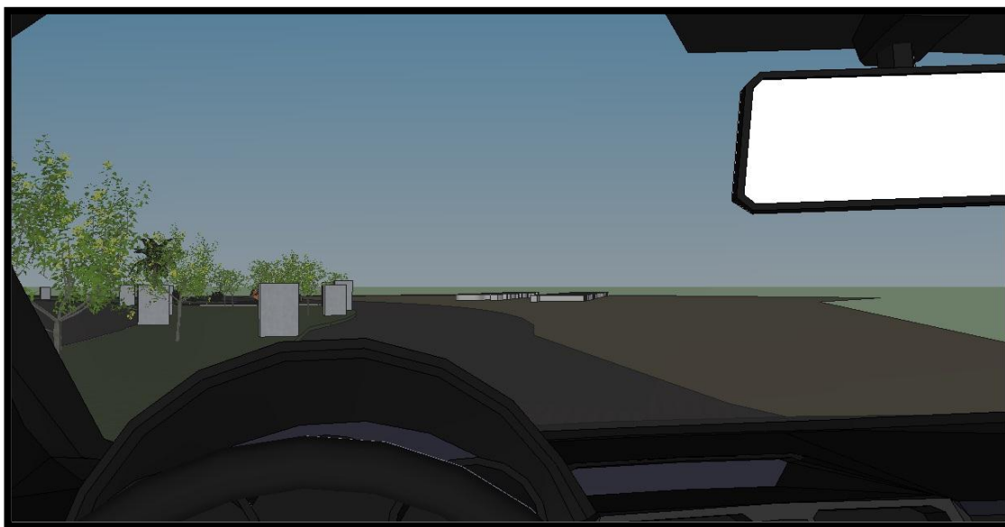
Figura 5.22 Incorrecta colocación de MUPI en retorno (VISTA DEL USUARIO DE CARRETERA PRINCIPAL)
