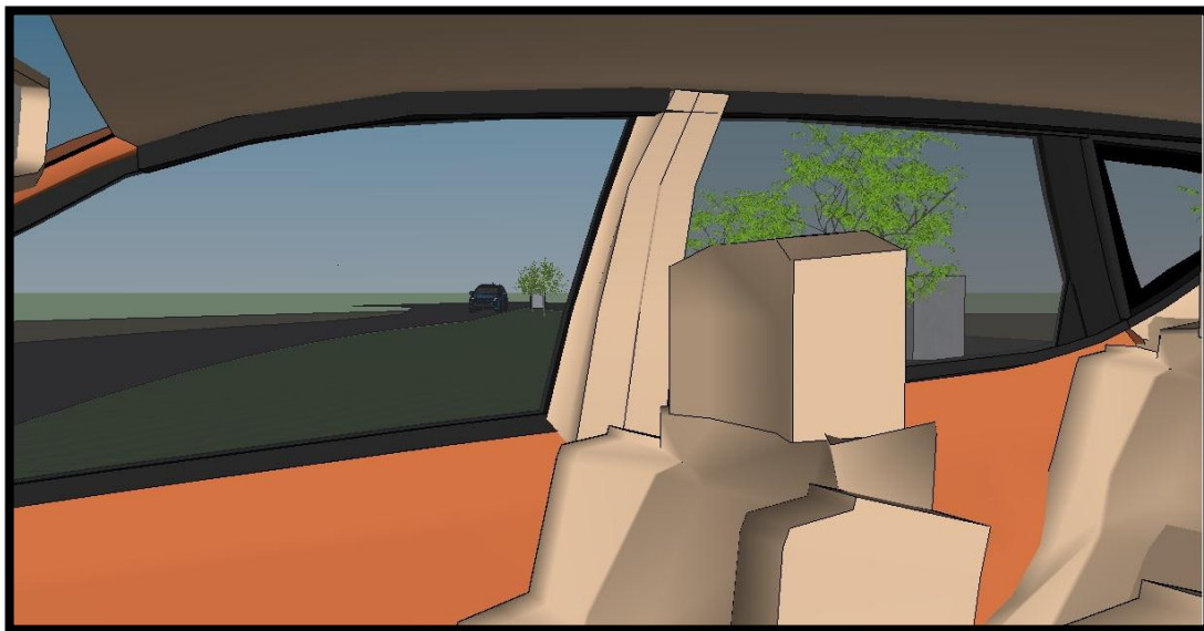
Figura 5.25 Correcta colocación de MUPI sin obstaculizar la visual de los conductores que utilizan el retorno (VISTA DEL USUARIO DEL RETORNO)
