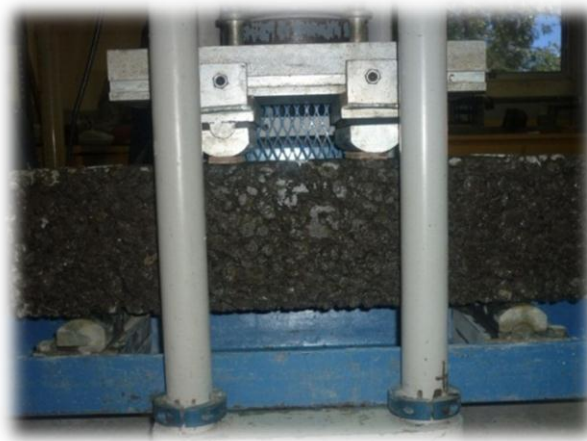
FIGURA 2.38 – Posición del espécimen de concreto para el Ensayo a Flexión por el Método de la Carga aplicada en el Tercio Medio del claro.
