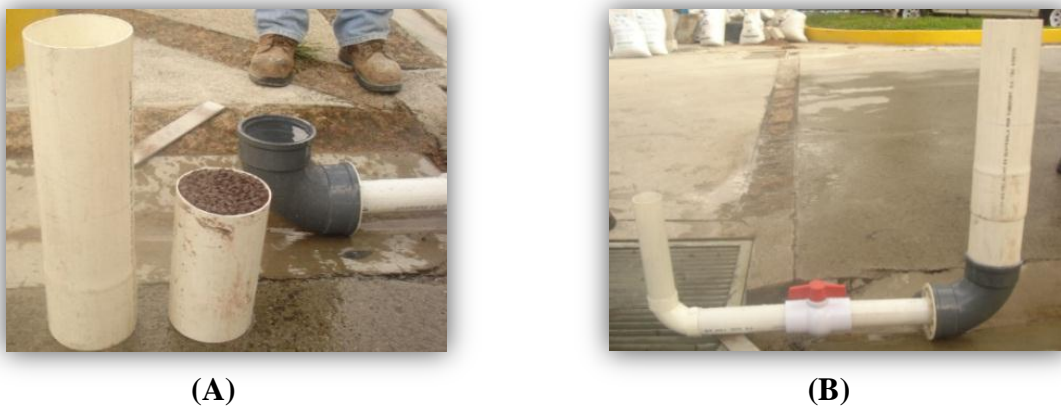
FIGURA 3.20 – (A) Especímen de concreto permeable a ensayarse, (B) Permeámetro de carga variable elaborado en el CI – ISCYC.
