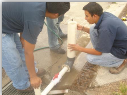
FIGURA 3.21 – Ensayo de Permeabilidad en laboratorio del Concreto Permeable
