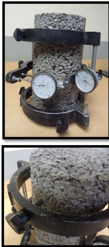
FIGURA 3.18 – Colocación del anillo compresómetro – extensómetro para el Ensayo de Módulo de Elasticidad Estático.
