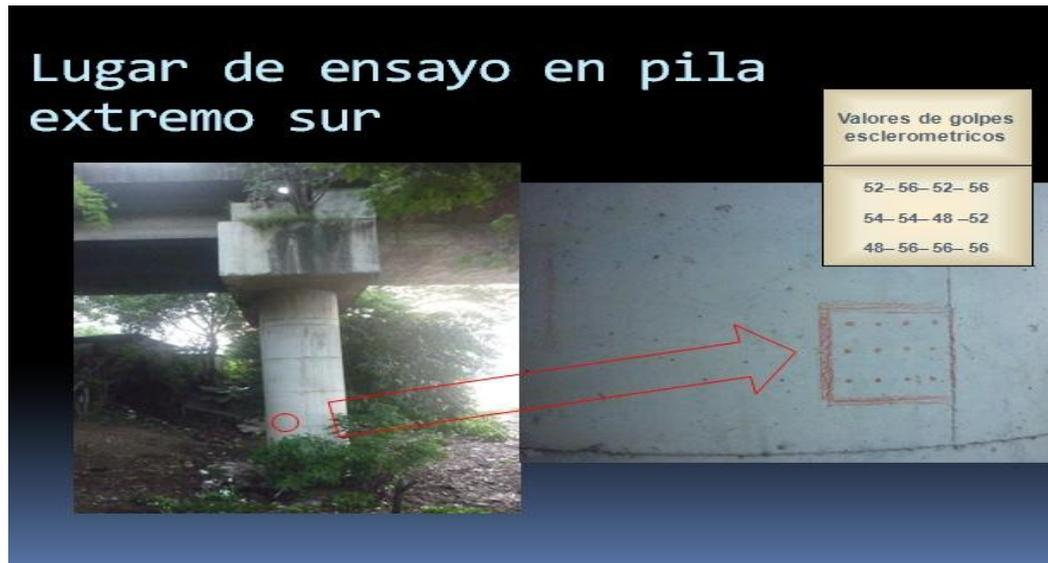
Fig. 4.9 Lugar donde se realizó el ensayo no destructivo del esclerómetro conforme a ASTM C 805-09
