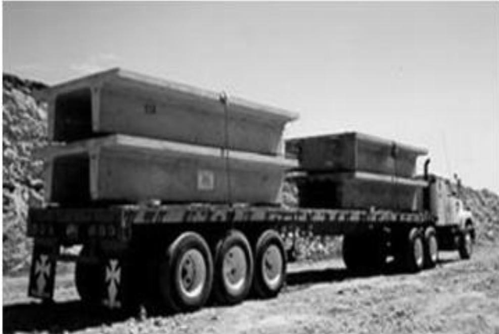
Fig. 2.9 Tracto con semi remolque acoplado
