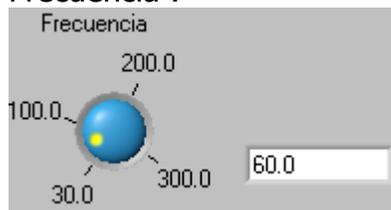
Esta perilla es la que controla la frecuencia de las señales analógicas que ya se estén generando, puede ser activada o modificada luego de que se hayan enviado los datos del software al hardware.
