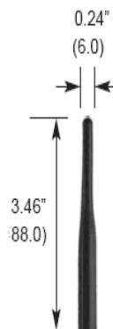
Figura 3.7 Dimensiones de Antena 900MHz  $\frac{1}{4}$  longitud de onda SMA
