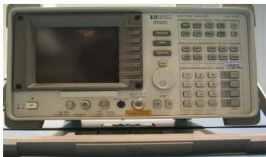
Figura 4.1 Analizador de Espectros HP 8592L, utilizado en las mediciones para caracterizar el AETR construido.
