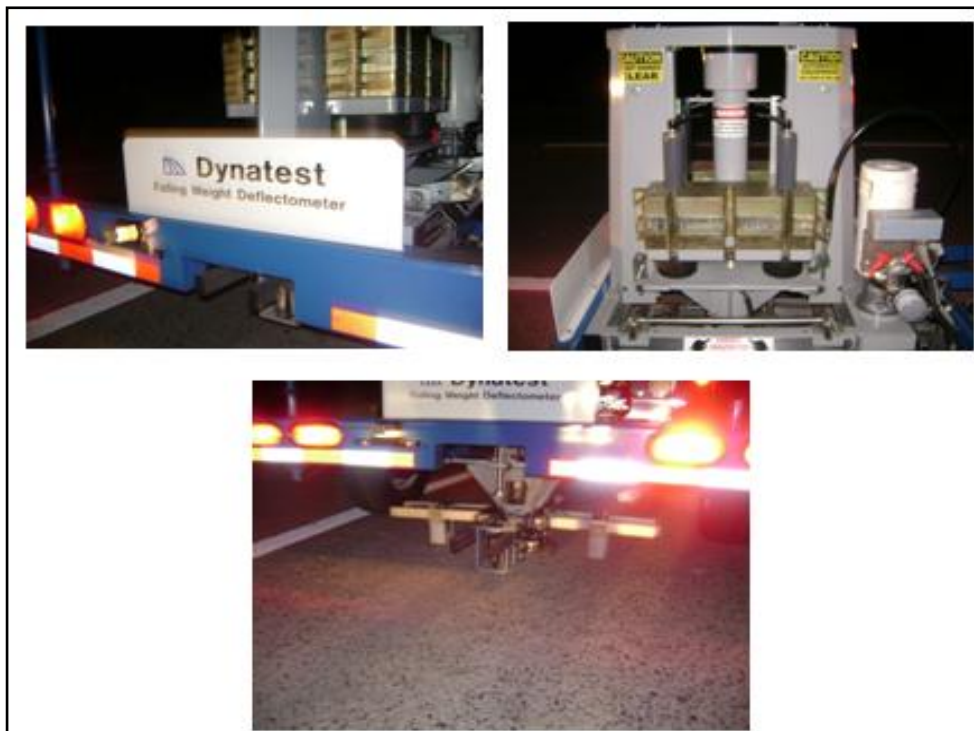
FIGURA 4.9: Falling Weight Deflectometer utilizado para realizar los trabajos en el tramo de análisis.
