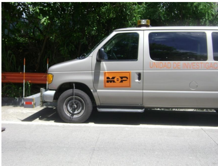
FIGURA 4.7 Perfilómetro laser utilizado para la medición del Índice de Rugosidad Internacional y Escalonamiento.
