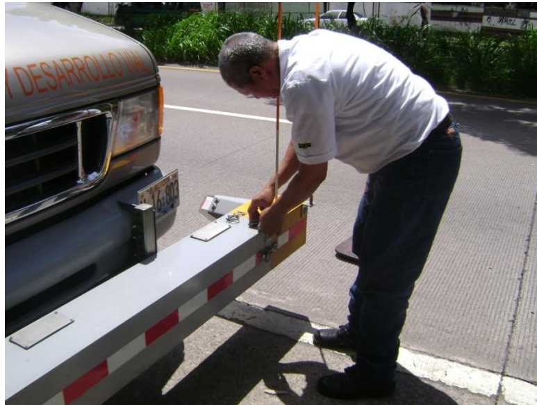
FIGURA 4.8 Preparación de Perfilómetro laser utilizado para la medición del Índice de Rugosidad Internacional y Escalonamiento.
