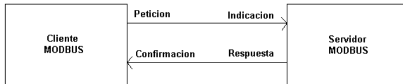
Figura 1. 1 Mensajes en el Modelo Cliente-Servidor de Modbus.
