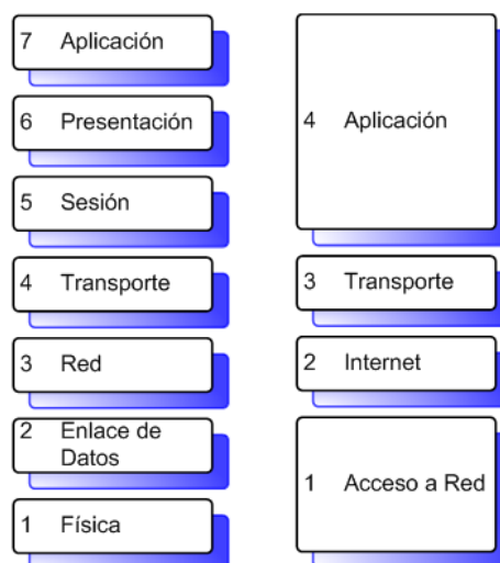
Figura 3.3 Comparación entre el modelo OSI y TCP/IP
