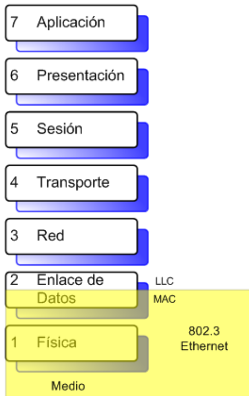
Figura 3.4 Ubicación de Ethernet 802.3 dentro del Modelo OSI
