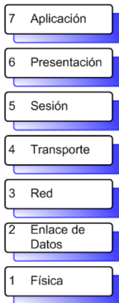
Figura 3.1 Capas del Modelo OSI
