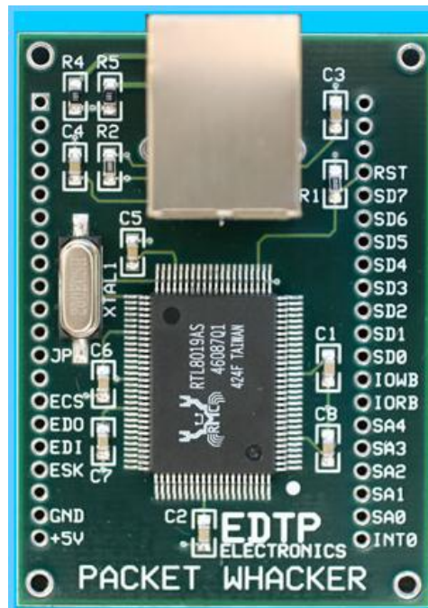
Figura 5.1. RTL8019AS embebido en PACKET WHACKER
