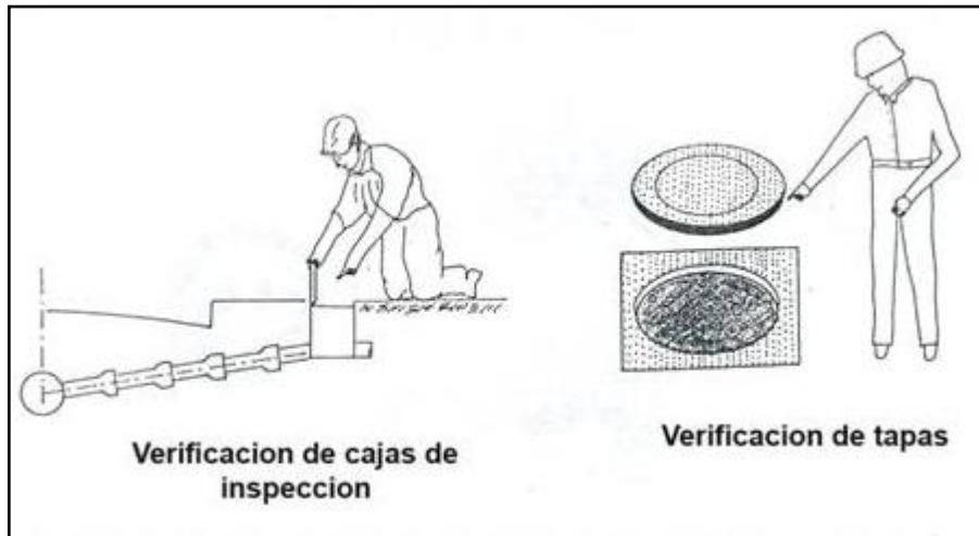
Figura 7.7.3. Verificación de cajas de los registros domiciliarios y de las tapas.
