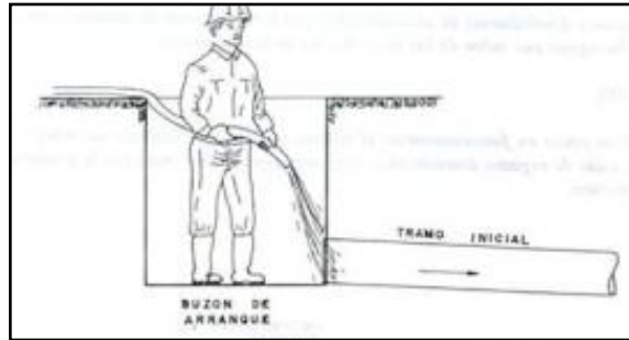
Figura 7.7.5. Limpieza de los tramos iniciales de los colectores.
