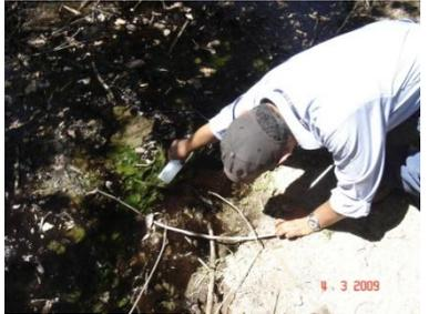
El muestreo en ríos se realizó en la sección del río con mayor profundidad, en la cual hubiera circulación de agua.
