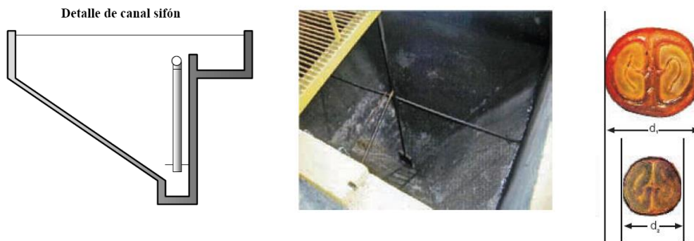
Figura 23. Detalle de canal de sifón, para clasificación hidrostática.
