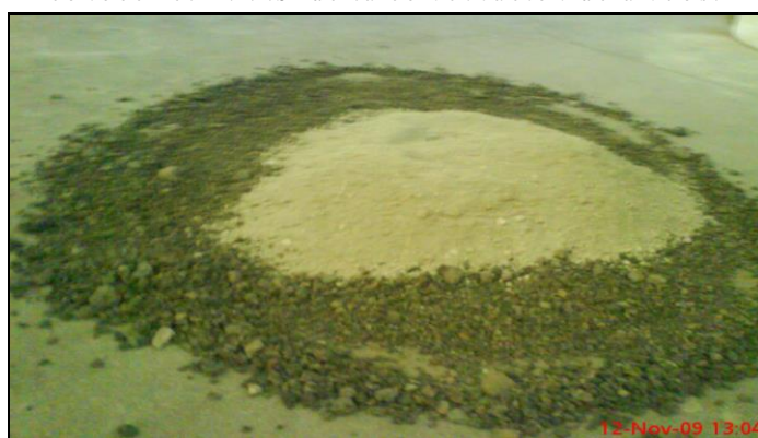
Figura 3.8.2. Muestra la combinación entre el material granular y la arena limosa para conocer el P.V.S de la combinación de ambos.
