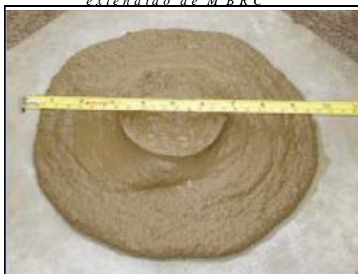
Figura 2.9.9. Muestra como se deben realizar las mediciones del diámetro extendido de M B R C 41
