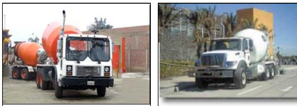
Figura 2.8.1.: Tipos de camión mezclador para transporte de concreto y MBRC 26 .
