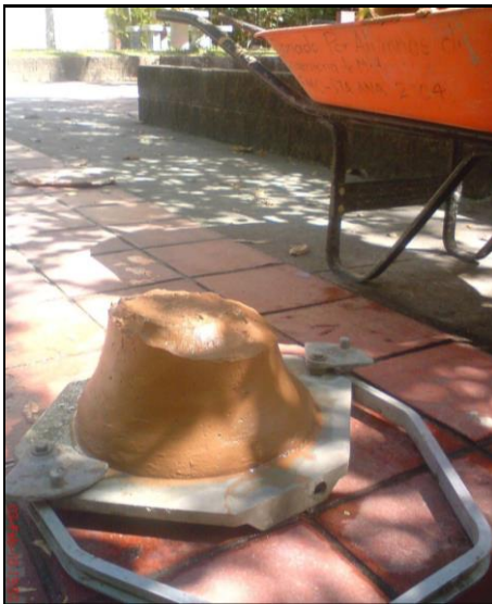
Fig. 5.1.2 Muestra el asentamiento y homogeneidad de la mezcla plástica.
