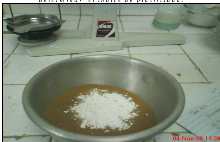
Fig. 3.8.4 Muestra la incorporación de cal al suelo pasante del tamiz N° 40 determinar el índice de plasticidad.
