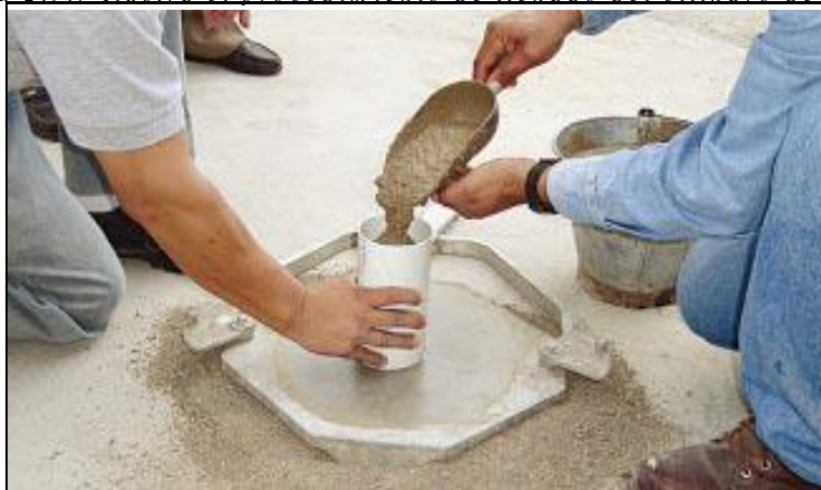
Figura 2.9.7 Ilustra el procedimiento de llenado del cilindro de flujo 39
