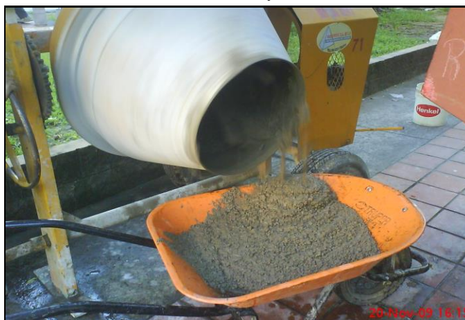
Fig. 5.1.3 Muestra la mezcla granular elaborada de forma mecánica previa a la elaboración de especímenes.
