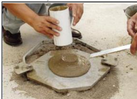
Figura 2.9.8. Muestra la forma de levantar el cilindro de flujo 40 .
