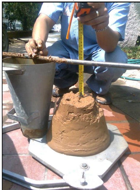
Figura 4.3.1: Muestra el proceso de medición del revenimiento de la mezcla de material plástico.
