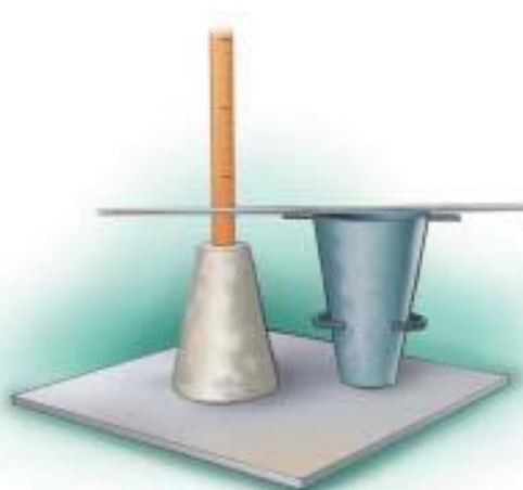
Figura 2.9.5: Muestra la forma de medición del revenimiento. 36
