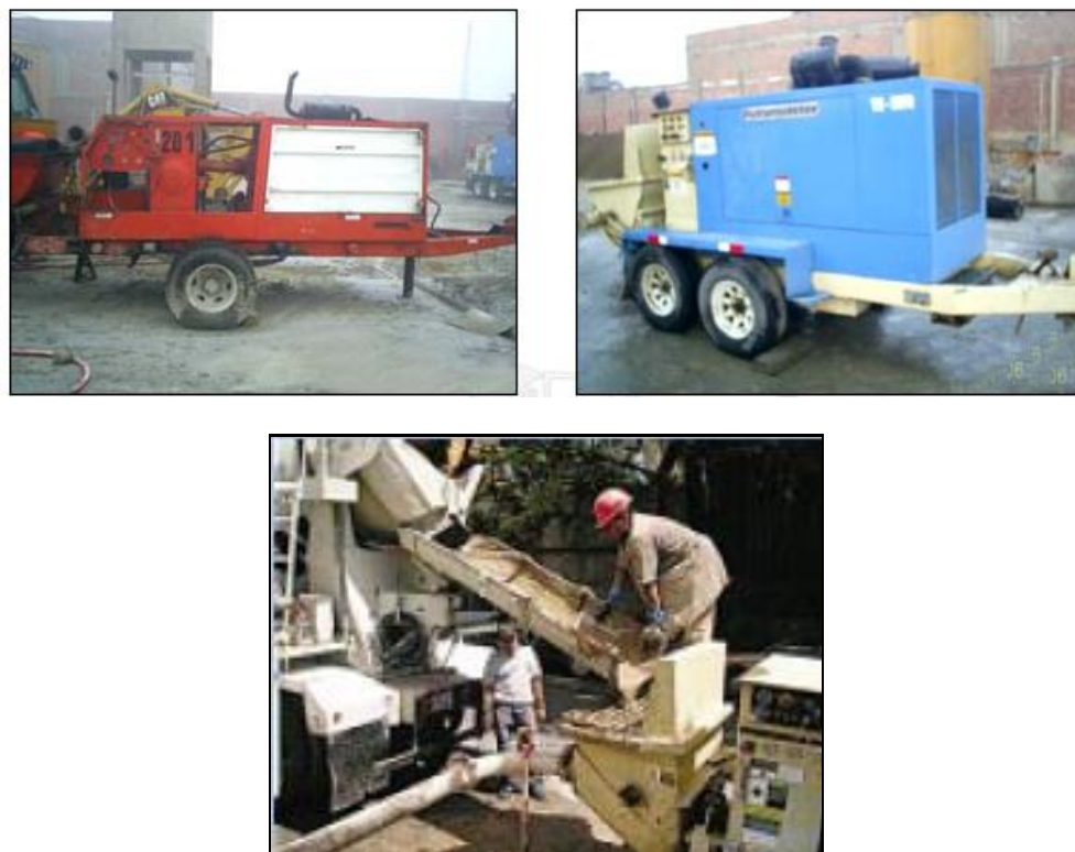
Fig.2.8.2 Modelo de bombas utilizadas para distribuir lo concreto 13 .
