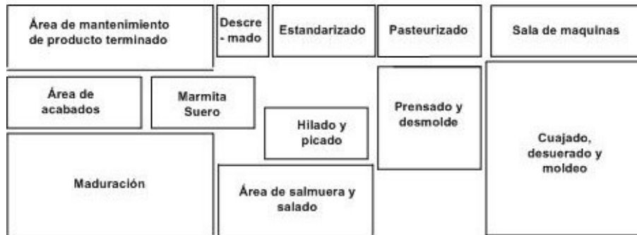
Ilustración 21: Distribución final para las áreas de producción de la planta de lácteos gourmet.
