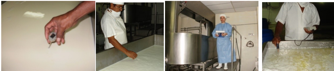
Imagen 2: Control de temperatura y Ph para cuajado (cuba de cuajo)
