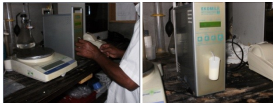
Imagen 1: Toma de muestras en analizador de sustancias (leche)
