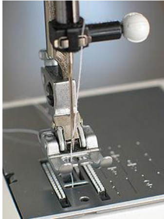
Figura 10: Aguja y placa de Transporte de Tela de una máquina de Coser
