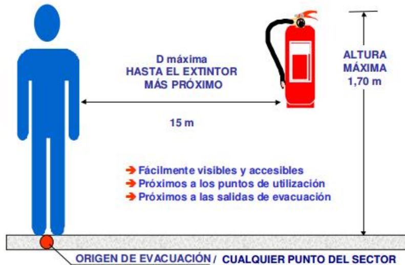
Ilustración 128: Situación y Emplazamiento de los Extintores
