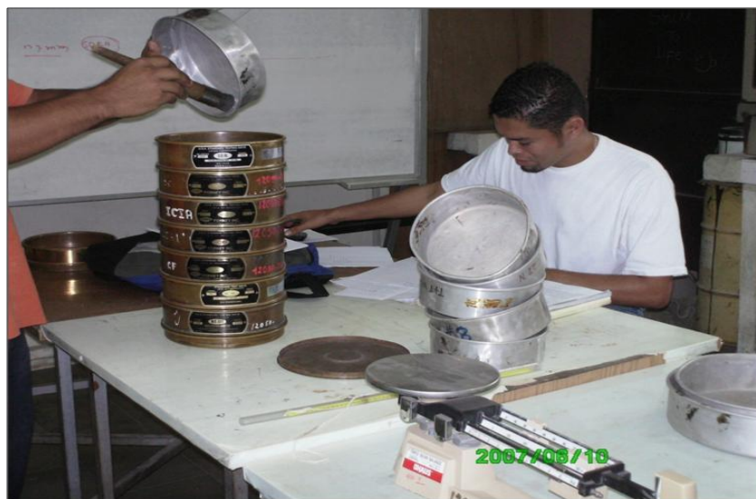
- Fotografía N° 4.1 Ensayo granulométrico al agregado fino.
