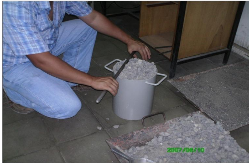
- Fotografía 4.4 Proceso de enraizado del agregado grueso.
