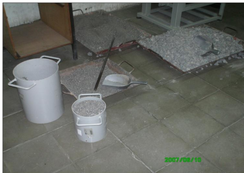
- Fotografía 4.5 Moldes utilizados para los pesos volumétricos sueltos y varillados.
