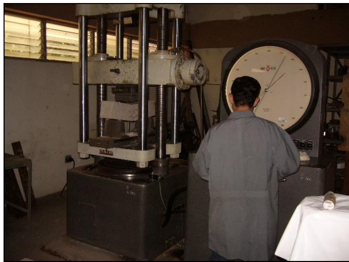
- Fotografía 4.17 Ensayo a la flexión de vigas de concreto, en el laboratorio de suelos y materiales de la Facultad de Ingeniería y Arquitectura de la Universidad de El Salvador tomados de las pruebas de campo realizadas en Santa Ana.
