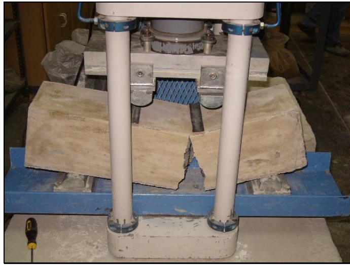
- Fotografía 4.16 Ensayo a la flexión de vigas de concreto, en el laboratorio del Instituto Salvadoreño del Cemento y el Concreto, ISCYC, los especímenes corresponden a las pruebas de campo realizadas en San Miguel.
