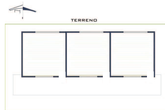
(Fig. 21) Ubicación recomendable de vanos de ventanas.
