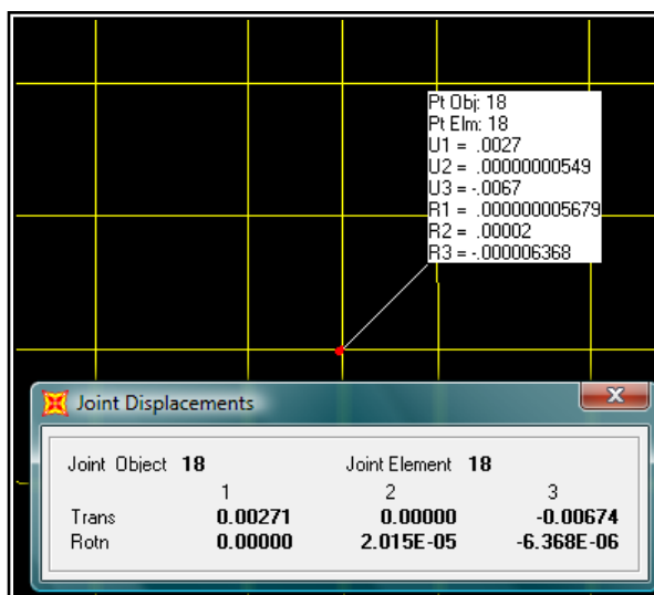
FIG. 4.95 Ventana de resultados de deformaciones en apoyo central de pila.
