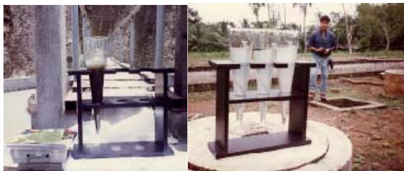
Figura 7.8 Conos Imhoff para determinar cantidad de sólidos sedimentables (SS)
