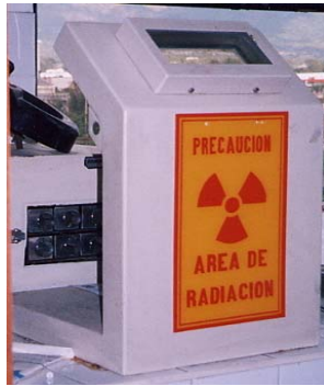
Fig N° 2.6 Contenedor de las fuentes
