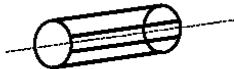
Figura 1.10 Esta figura muestra una representación de dos arcos los cuales se cortocircuitan por barras de cobre
