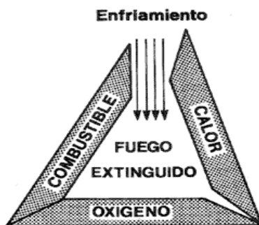
Figura 18: Método de Extinción por Enfriamiento
