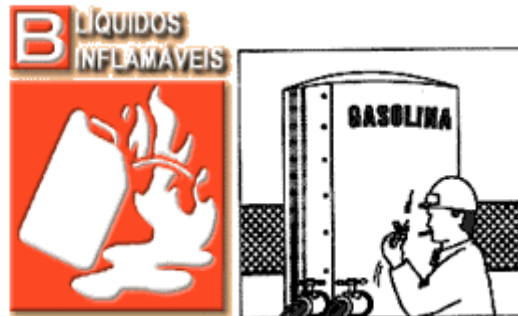
Figura 15: Líquidos inflamables como gasolina producen incendio Clase B
