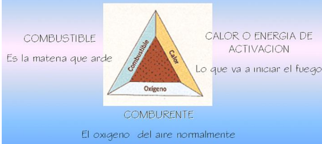
Figura 11: Triángulo del Fuego
