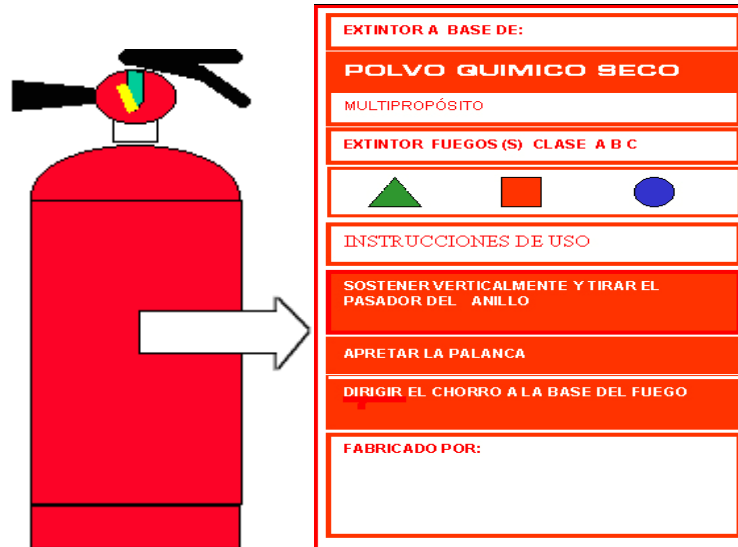
Figura 27: Etiqueta de Identificación del Extintor
