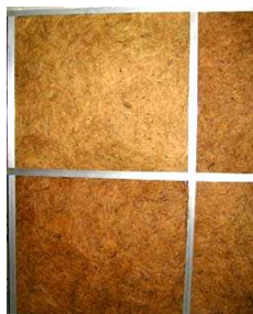
Figura 84. Muestra de la loseta de fibra de estopa de coco, en forma laminar aplicada como aislante de calor, cielo falso
