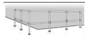
Imagen #2: Vallado de esquinas y alrededor de los procesos unitarios
