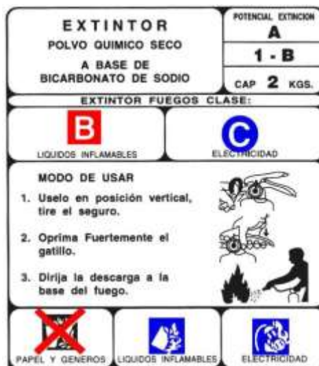
Imagen #25: Etiqueta de identificación de tipo de extintor
